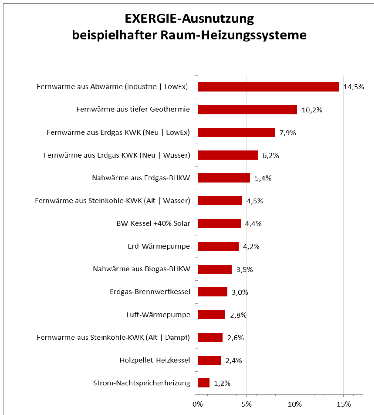
Abbildung 86: Abbildung der Exergieausnutzung durch Einzeltechnologien für die Raumwärmeversorgung auf Basis einer historischen Bewertungsmethodik
