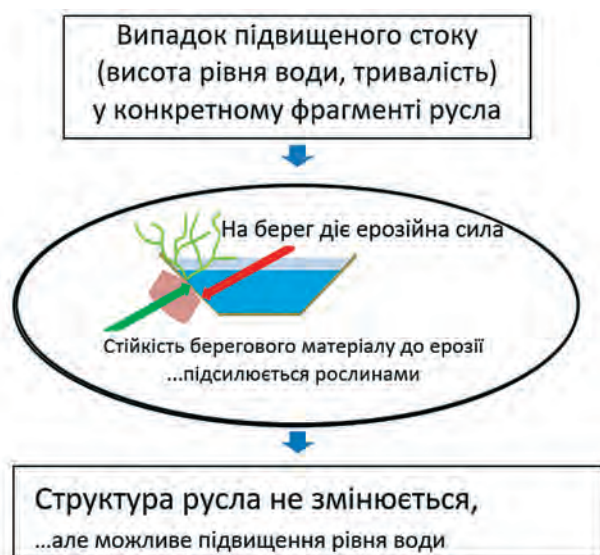
Рисунок 14: Вплив паводка на береговий матеріал із деревною рослинністю. (Джерело: Dittrich 2021)
