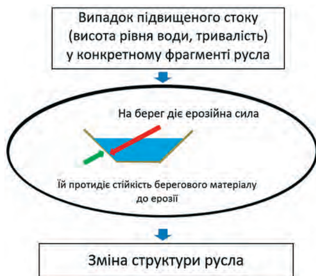
Рисунок 13: Вплив паводка на береговий матеріал без деревної рослинності. (Джерело: Dittrich 2021)
