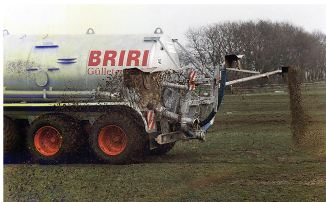
❷ Рис. 18: Разбрызгивающая форсунка для навоза
