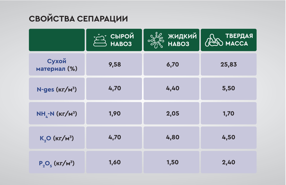
❶ Инфографик 4: Свойства навоза до и после сепарации.
