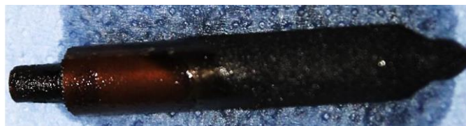
Abbildung 5-10: Angriff einer Düsenadel aus Stahl durch (nicht aufbereitetes) Produktöl aus der Dieselwest-Anlage. Links: Neue Düsenadel; rechts: Düsenadel nach einer Woche im Produktöl
