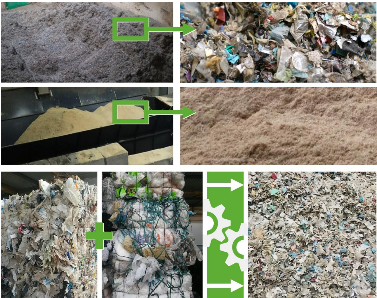
Abbildung 5-5: Einsatzstoffe der Dieselwest-Pilotanlage, Ennigerloh. Oben: Ersatzbrennstoff aus Restabfällen; Mitte: Sägemehl; unten: Kunststofffolien aus Bau- und Produktionsabfällen, die vor der Aufbereitung zerkleinert wurden
