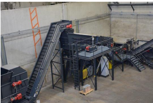
Abbildung 5-4: Brennstoffvorbehandlung in der Dieselwest-Pilotanlage, Ennigerloh. Links: Mechanische Aufbereitung mit Schwingwellensieb und Metallabscheidung (NE und Fe); Rechts beheizte Schnecken in Kaskadenschaltung zur Eduktvortrocknung
