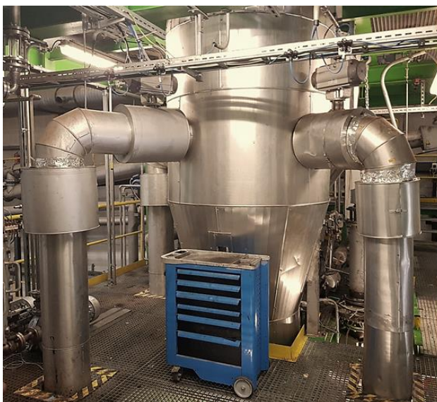
Abbildung 5-7: Reaktor der Dieselwest-Pilotanlage, Ennigerloh, mit oberem (links, mit Ölzuführung von den vier Turbinen) und unterem Behälter (rechts, mit Eintragsschnecke mit rotem Antriebsmotor im Vordergrund)
