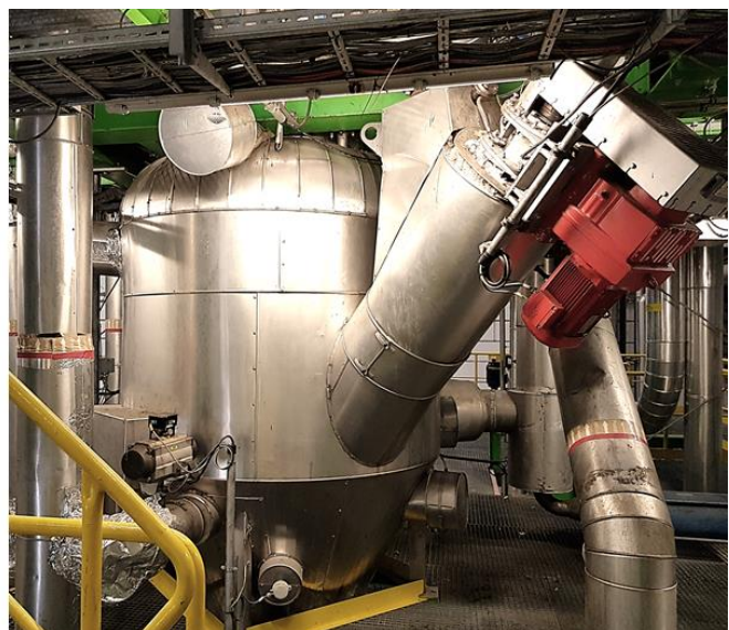
Abbildung 5-7: Reaktor der Dieselwest-Pilotanlage, Ennigerloh, mit oberem (links, mit Ölzuführung von den vier Turbinen) und unterem Behälter (rechts, mit Eintragsschnecke mit rotem Antriebsmotor im Vordergrund)
