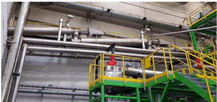
Abbildung 5-4: Brennstoffvorbehandlung in der Dieselwest-Pilotanlage, Ennigerloh. Links: Mechanische Aufbereitung mit Schwingwellensieb und Metallabscheidung (NE und Fe); Rechts beheizte Schnecken in Kaskadenschaltung zur Eduktvortrocknung
