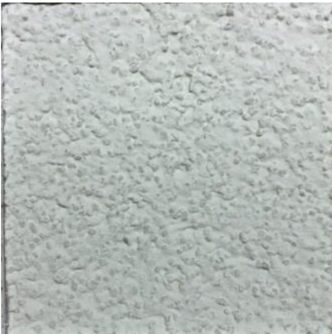
Abbildung 72: Ansicht der Variante 9 nach 6 Stunden Betauungsdauer.
