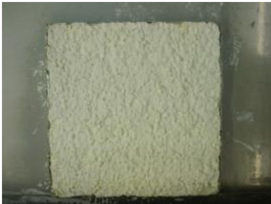
Abbildung 40: die 4 Parallelen der Variante 6 (mineralischer Putz mit Silikonharzfarbe) zum Ende der Versuchslaufzeit
