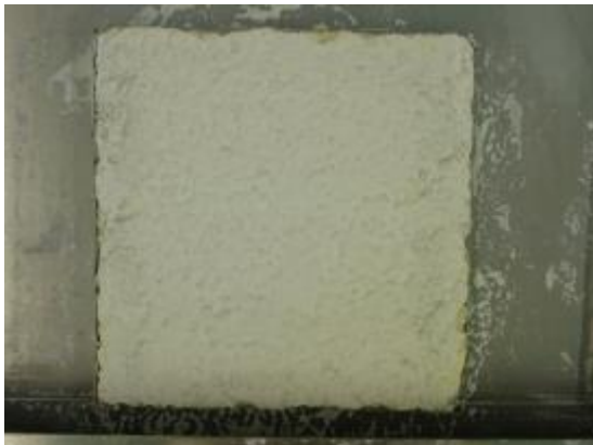
Abbildung 42: die 4 Parallelen der Variante 7 (mineralischer Putz mit Dispersionsfarbe) zum Ende der Versuchslaufzeit
