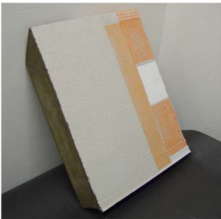
Abbildung 10: Testprüfkörper mit dem typischen WDVS-Aufbau
