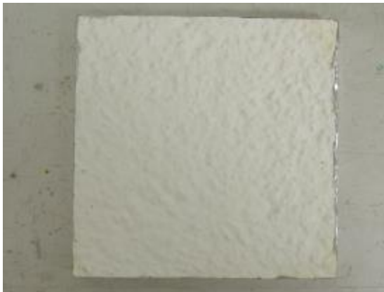
Abbildung 56: die 4 Parallelen der Variante 14 (silikatischer Putz mit Silikonharzfarbe) zum Ende der Versuchslaufzeit
