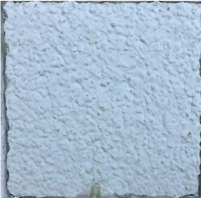
Abbildung 71: Ansicht der Variante 8 nach 6 Stunden Betauungsdauer.
