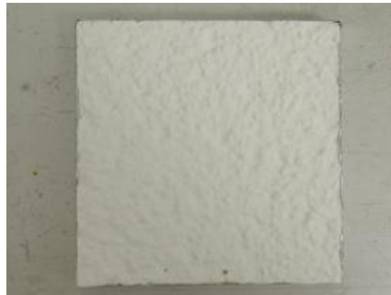
Abbildung 56: die 4 Parallelen der Variante 14 (silikatischer Putz mit Silikonharzfarbe) zum Ende der Versuchslaufzeit
