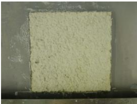
Abbildung 38: die 4 Parallelen der Variante 5 (mineralischer Putz ohne Anstrich) zum Ende der Versuchslaufzeit
