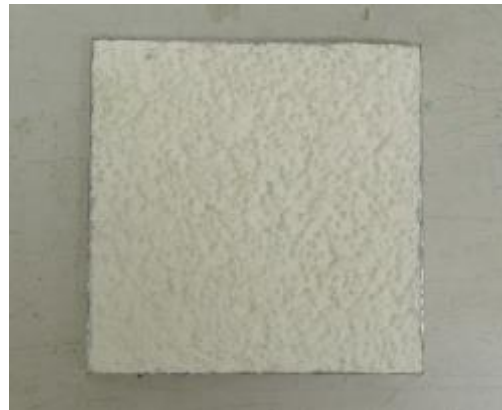
Abbildung 46: die 4 Parallelen der Variante 9 (Dispersions-Silikatputz ohne Anstrich) zum Ende der Versuchslaufzeit
