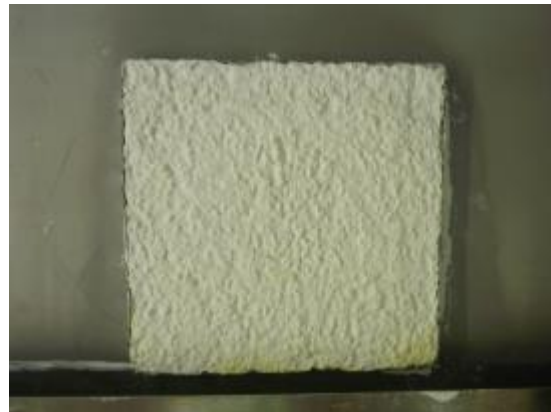
Abbildung 40: die 4 Parallelen der Variante 6 (mineralischer Putz mit Silikonharzfarbe) zum Ende der Versuchslaufzeit
