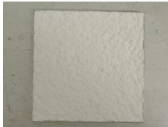
Abbildung 48: die 4 Parallelen der Variante 10 (Dispersions-Silikatputz mit Kieselol-Silikatfarbe) zum Ende der Versuchslaufzeit
