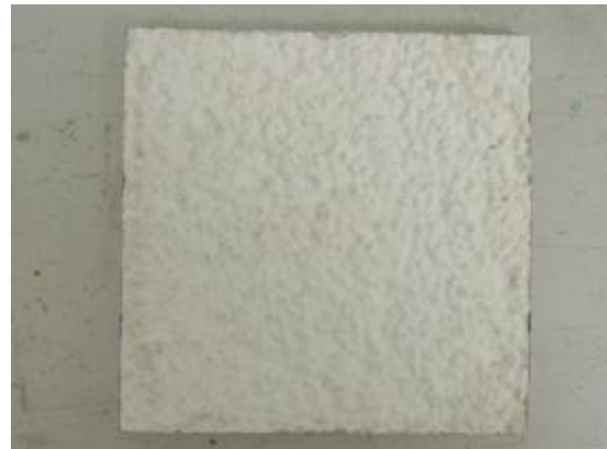
Abbildung 52: die 4 Parallelen der Variante 12 (silikatischer Putz ohne Anstrich) zum Ende der Versuchslaufzeit
