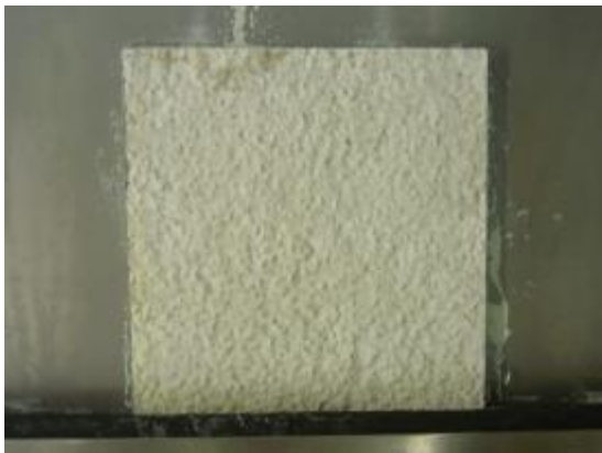
Abbildung 32: die 4 Parallelen der Variante 2 (Silikonharzputz mit Kieselisol-Silikatfarbe) zum Ende der Versuchslaufzeit
