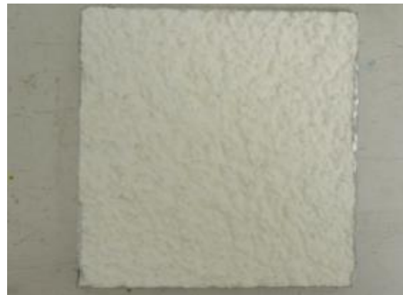
Abbildung 58: die 4 Parallelen der Variante 15 (silikatischer Putz mit Dispersionsfarbe) zum Ende der Versuchslaufzeit
