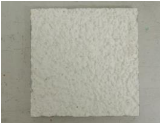
Abbildung 52: die 4 Parallelen der Variante 12 (silikatischer Putz ohne Anstrich) zum Ende der Versuchslaufzeit
