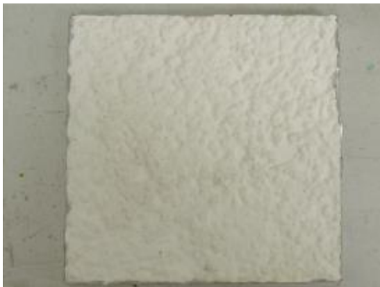
Abbildung 58: die 4 Parallelen der Variante 15 (silikatischer Putz mit Dispersionsfarbe) zum Ende der Versuchslaufzeit
