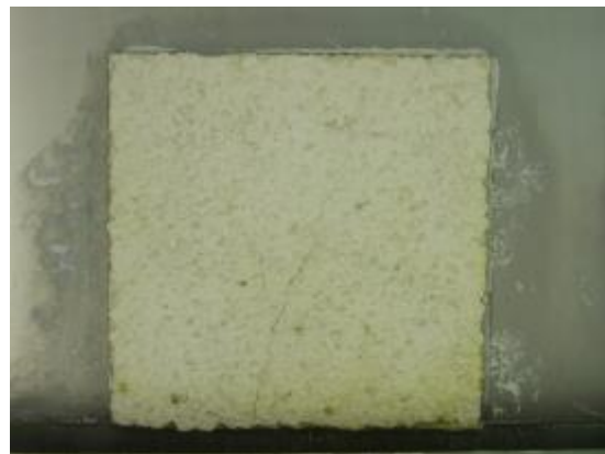
Abbildung 38: die 4 Parallelen der Variante 5 (mineralischer Putz ohne Anstrich) zum Ende der Versuchslaufzeit
