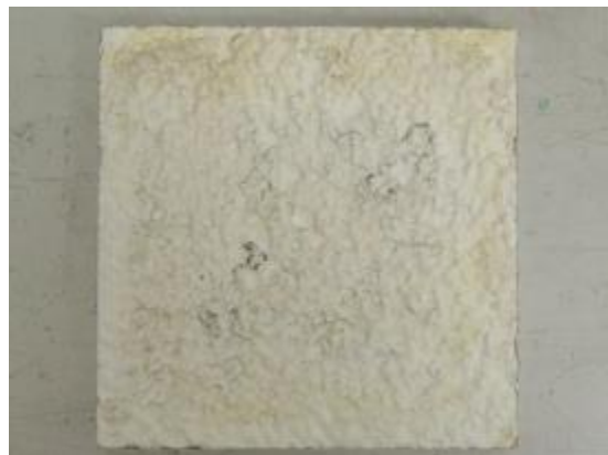
Abbildung 54: die 4 Parallelen der Variante 13 (silikatischer Putz mit Dispersions-Silikatfarbe) zum Ende der Versuchslaufzeit
