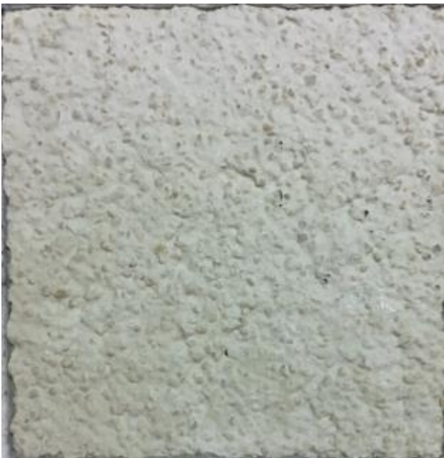
Abbildung 68: Ansicht der Variante 5 nach 6 Stunden Betauungsdauer.
