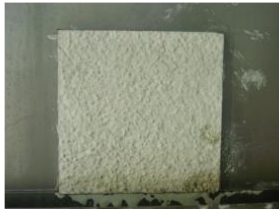
Abbildung 32: die 4 Parallelen der Variante 2 (Silikonharzputz mit Kieselisol-Silikatfarbe) zum Ende der Versuchslaufzeit
