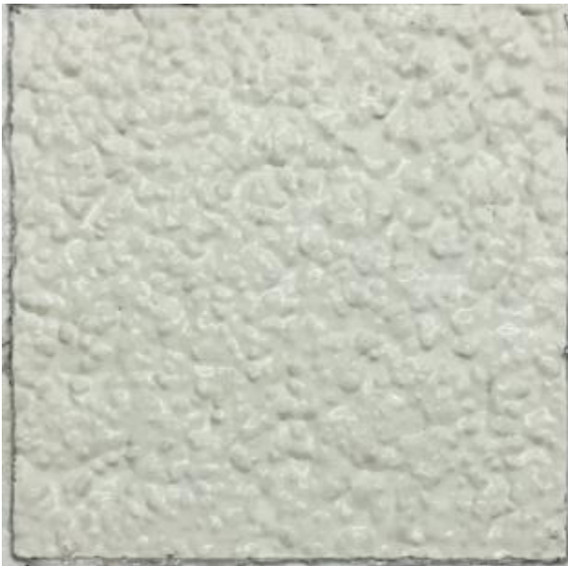
Abbildung 78: Ansicht der Variante 15 nach 6 Stunden Betauungsdauer.
