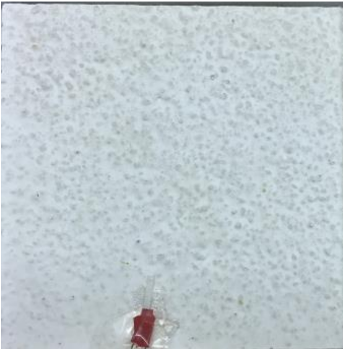
Abbildung 65: Ansicht der Variante 2 nach 6 Stunden Betauungsdauer.
