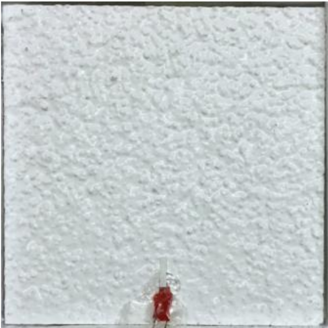
Abbildung 67: Ansicht der Variante 4 nach 6 Stunden Betauungsdauer.
