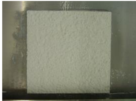
Abbildung 36: die 4 Parallelen der Variante 4 (Silikonharzputz mit Farbe mit bionischem Wirkprinzip) zum Ende der Versuchslaufzeit
