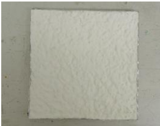
Abbildung 48: die 4 Parallelen der Variante 10 (Dispersions-Silikatputz mit Kieselol-Silikatfarbe) zum Ende der Versuchslaufzeit
