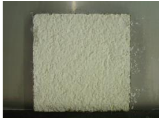
Abbildung 42: die 4 Parallelen der Variante 7 (mineralischer Putz mit Dispersionsfarbe) zum Ende der Versuchslaufzeit
