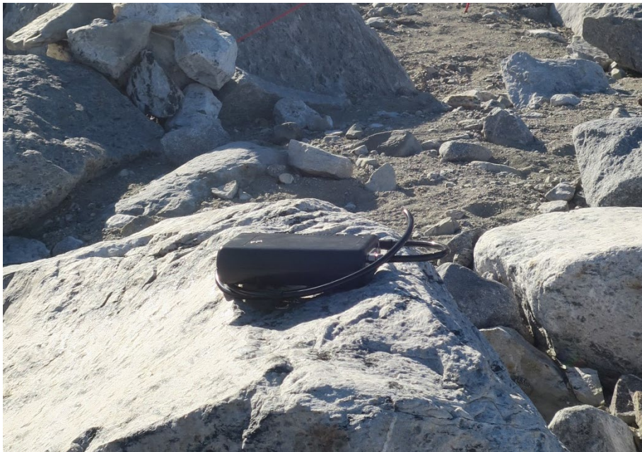
Abbildung 23: Das Rußmessgerät microAeth® / MA200
