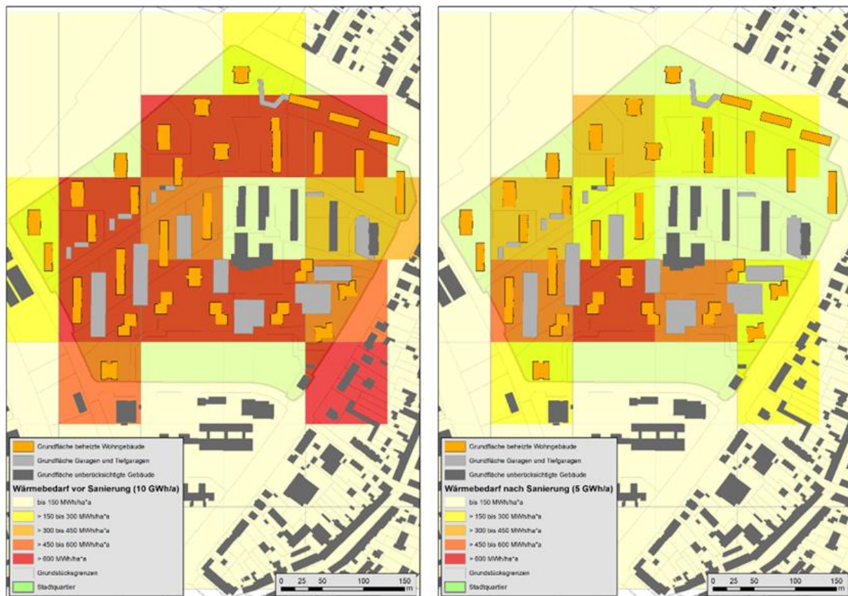
Abbildung 1.39: Wärmebedarfsdichten (MWh/(ha · a)) im Stadtquartier vor und nach energetischer Sanierung der Wohngebäude
