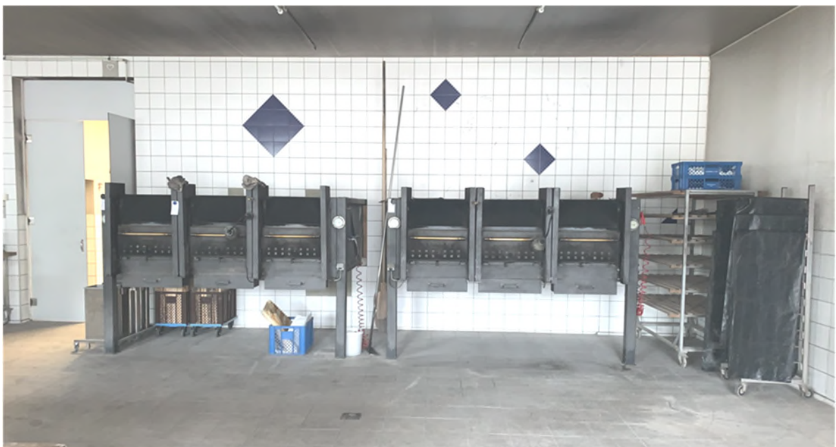
Abbildung 20: Herkömmliche mit geschlossenem Feuerraum betriebene Zeitbrandöfen (zwei identische Backöfen mit jeweils drei Backkammern).
