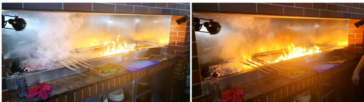
Abbildung 72: Rauchentwicklung während des Grillvorgangs und teilweise Regenerierung der Grillmulde (links), Flammenentwicklung während des Grillvorgangs (rechts).
