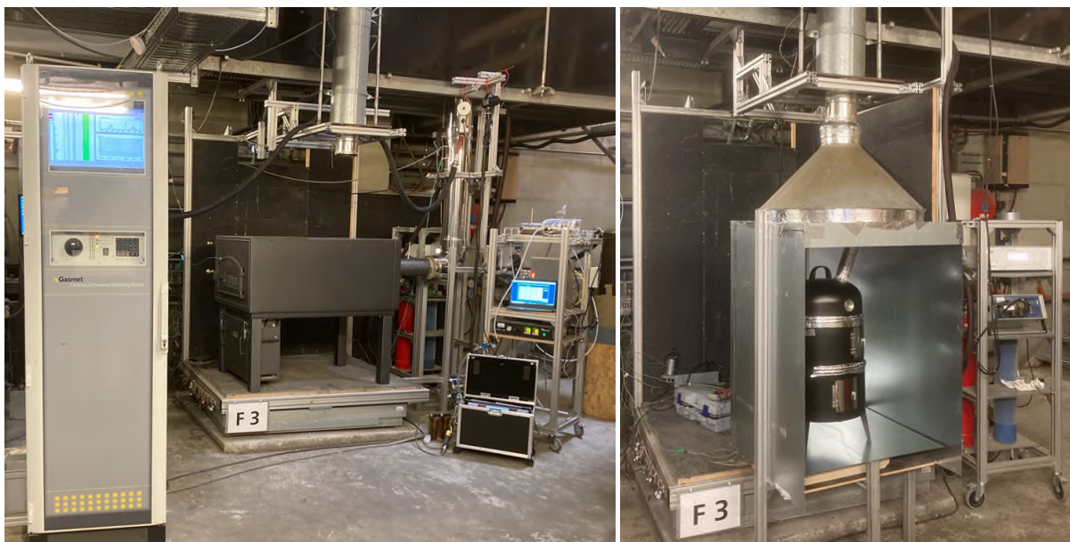
Abbildung 44: Klassischer Prüfstandsaufbau für die Untersuchung von Pizza- und Brotbacköfen (links) sowie von Räucherkammern (rechts).
