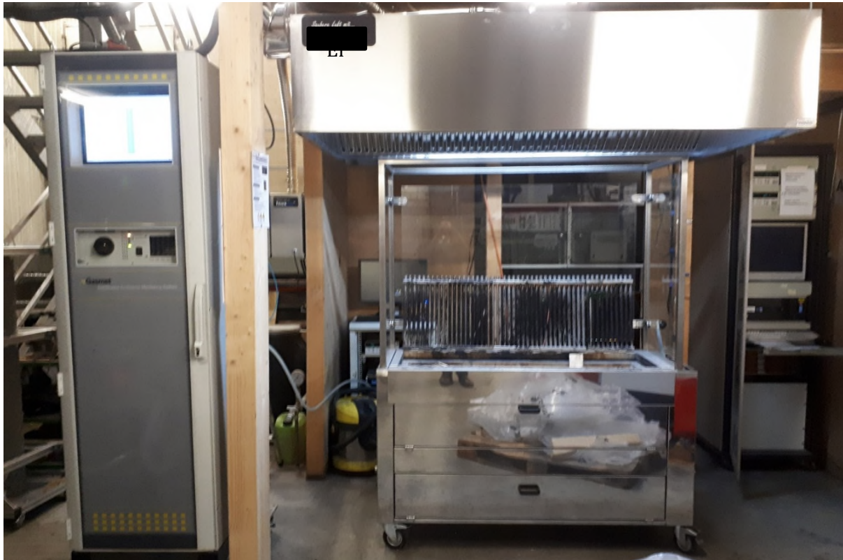
Abbildung 47: Holzkohlegrillanlage (im neuen nicht umgebauten Zustand) mit Dunstabzugshaube und integriertem Flammschutzfilter.
