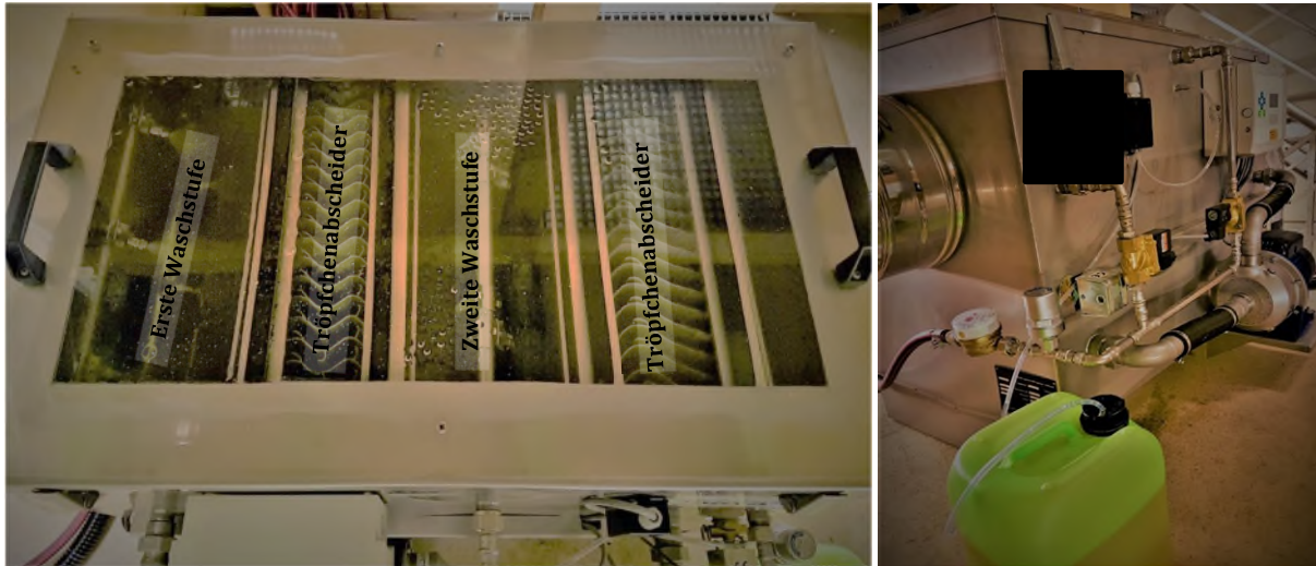
Abbildung 50: Zweistufiger Waschvorgang im Rauchgaswäscher (links), Dosierung vom Lösungsmittel in den Wäscher (rechts).
