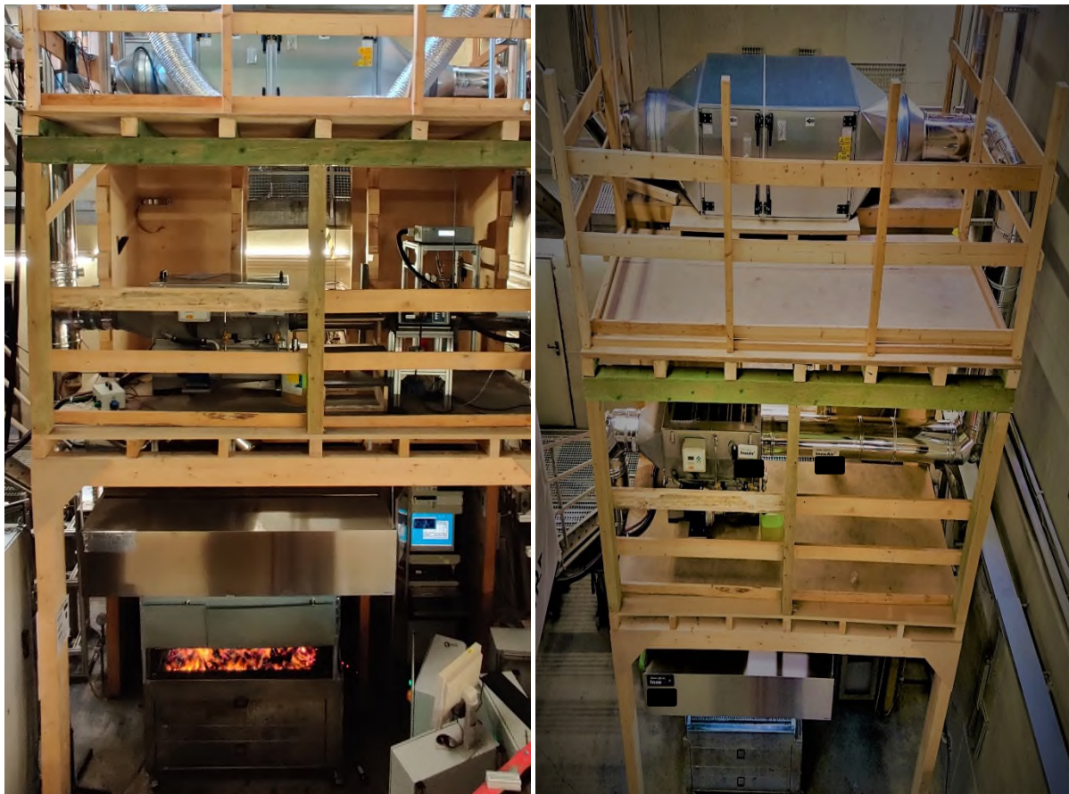
Abbildung 45: Gesamte technische Versuchseinrichtung für die Untersuchung von Holzkohlegrillanlagen.
