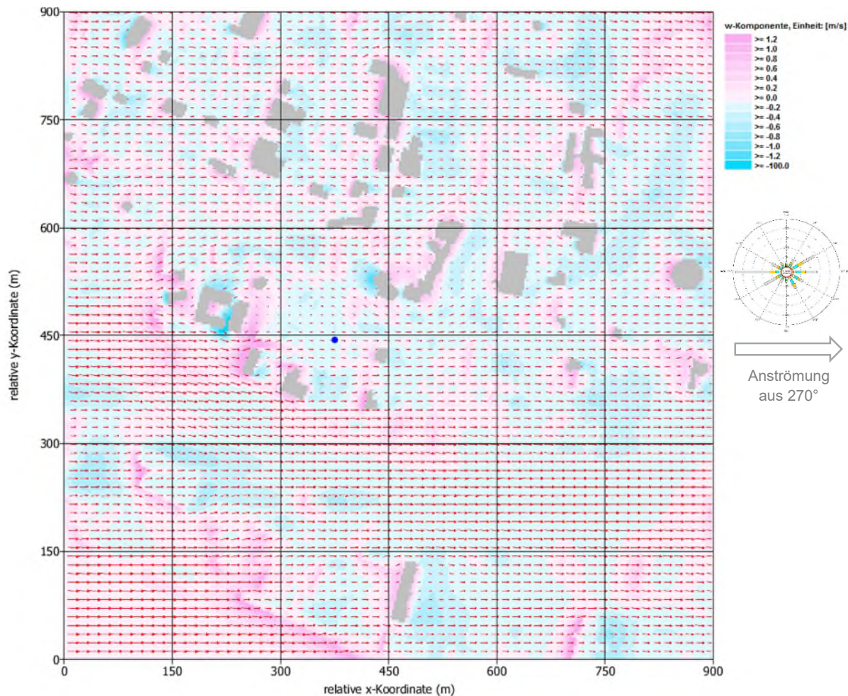
Abbildung 114: Großräumige Darstellung des dreidimensionalen Windfeldes im Modellgebiet in Göppingen bei Anströmung aus 270° (West) auf einer Höhe von 17,3 m über Geländeoberkante.
