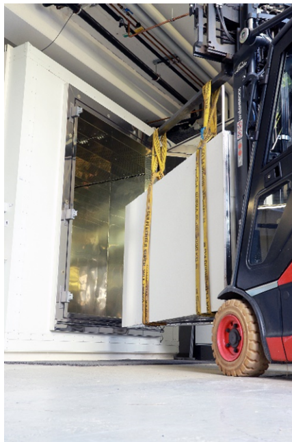
Abbildung 18: Beladung einer 30m 3 -Edelstahlprüfkammer mit einem Wandelement.
