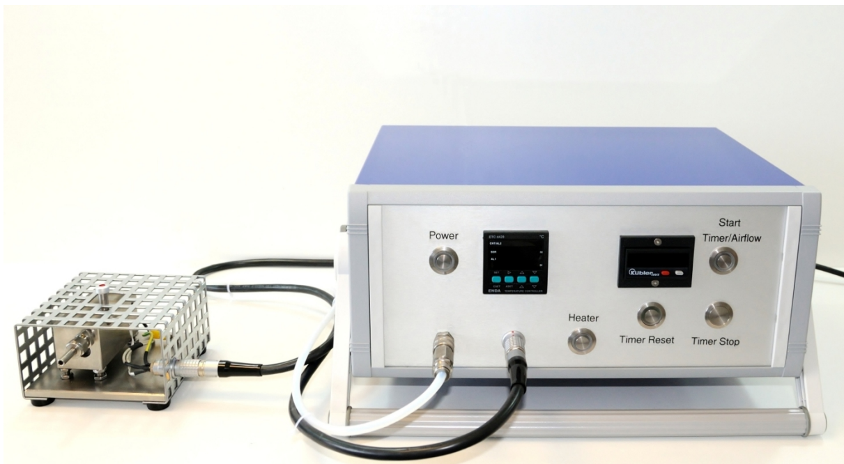
Abbildung 63: Liquid to Gas Vaporiser (LiGaVa).
