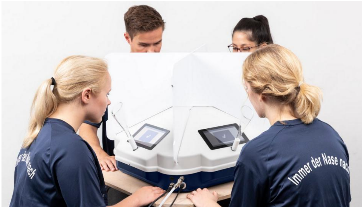
Abbildung 65: Geruchsbewertung an einem TO8-Evo-Olfaktometer.
