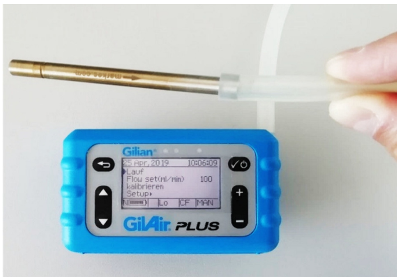
Abbildung 5: Probenahme-Equipment für GC-MS/GC-MS-Sniffing: Tenax®-Röhrchen und GilAir PLUS Probenahmepumpe.
