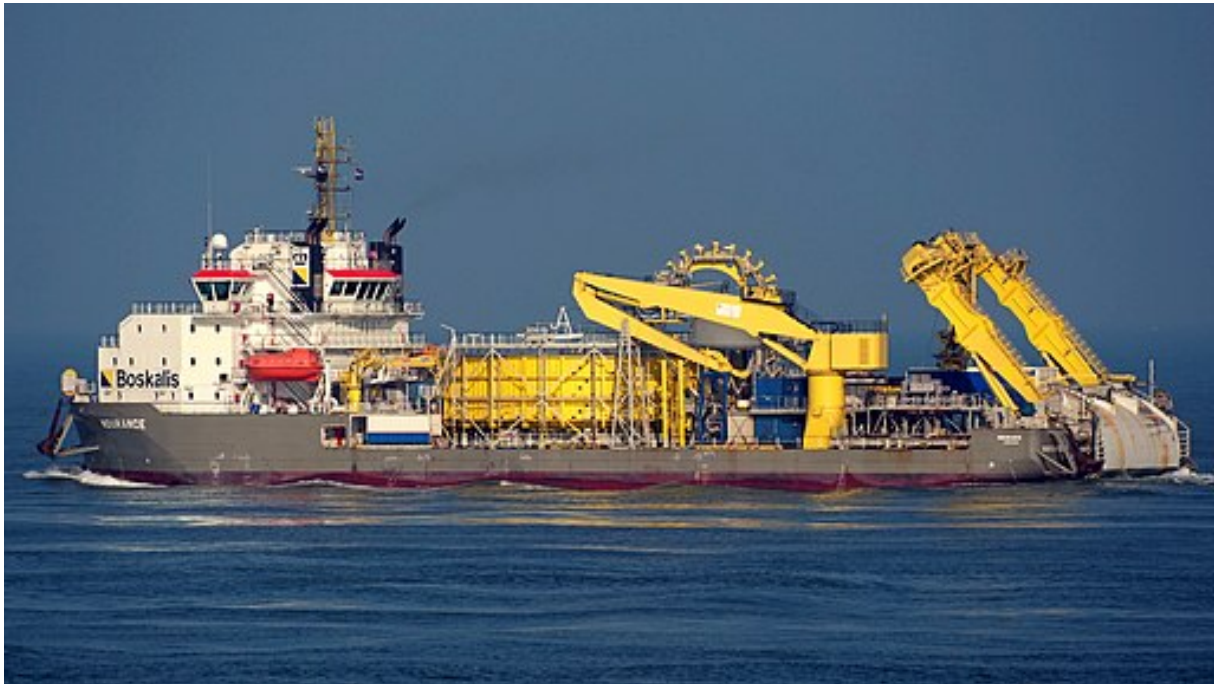
Abbildung 11: Verlegeschiff für Seekabel mit Kabeltrommel
