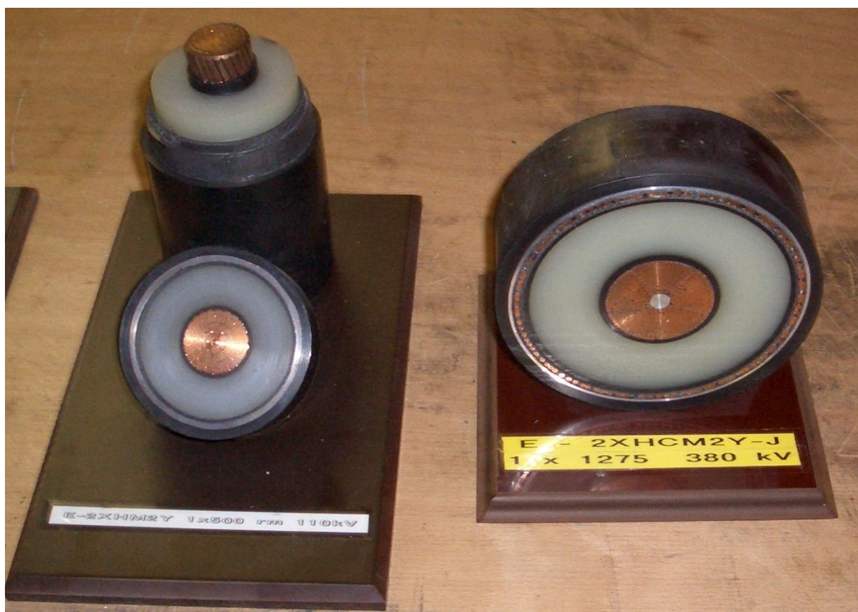
Abbildung 8: Erdkabel: 110 kV und 380 kV
