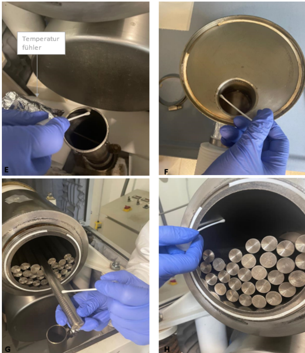
Abbildung Anhang 3: Probenahmestellen: E: Auslaufrohr F: Auslaufkopf G: Titan-Mahlstäbe H: Mahlrohr
