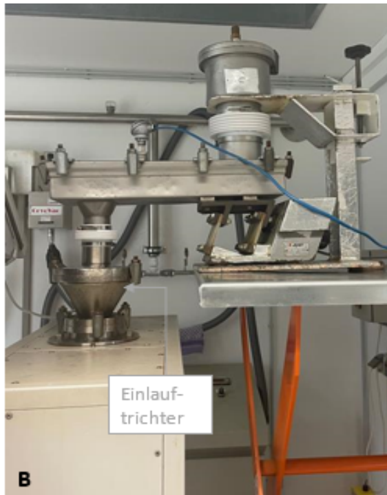
Abbildung Anhang 2A: Schwingmühle Palla VT-KM, KHD Humboldt Wedag (jetzt: MBE GmbH), geschlossenes System B: Einlauftrichter und Dosierrinne C: Auslaufrohr D: Titan-Mahlstäbe im Mahlrohr
