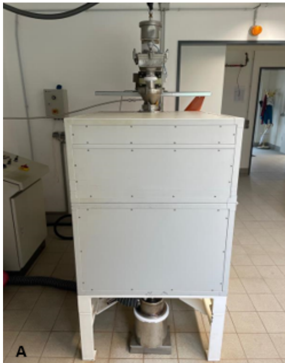
Abbildung Anhang 2A: Schwingmühle Palla VT-KM, KHD Humboldt Wedag (jetzt: MBE GmbH), geschlossenes System B: Einlauftrichter und Dosierrinne C: Auslaufrohr D: Titan-Mahlstäbe im Mahlrohr
