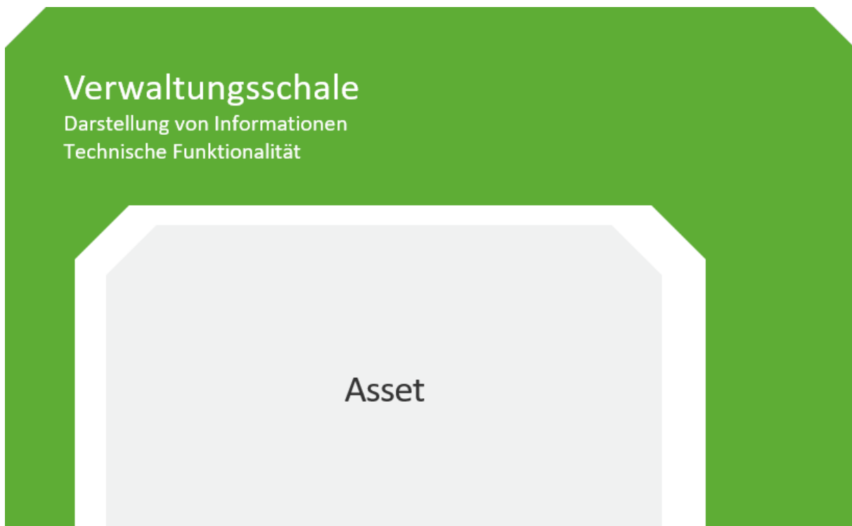
Abbildung 3: Industrie 4.0-Komponente nach IEC PAS 63088 (DIN SPEC 91345)
