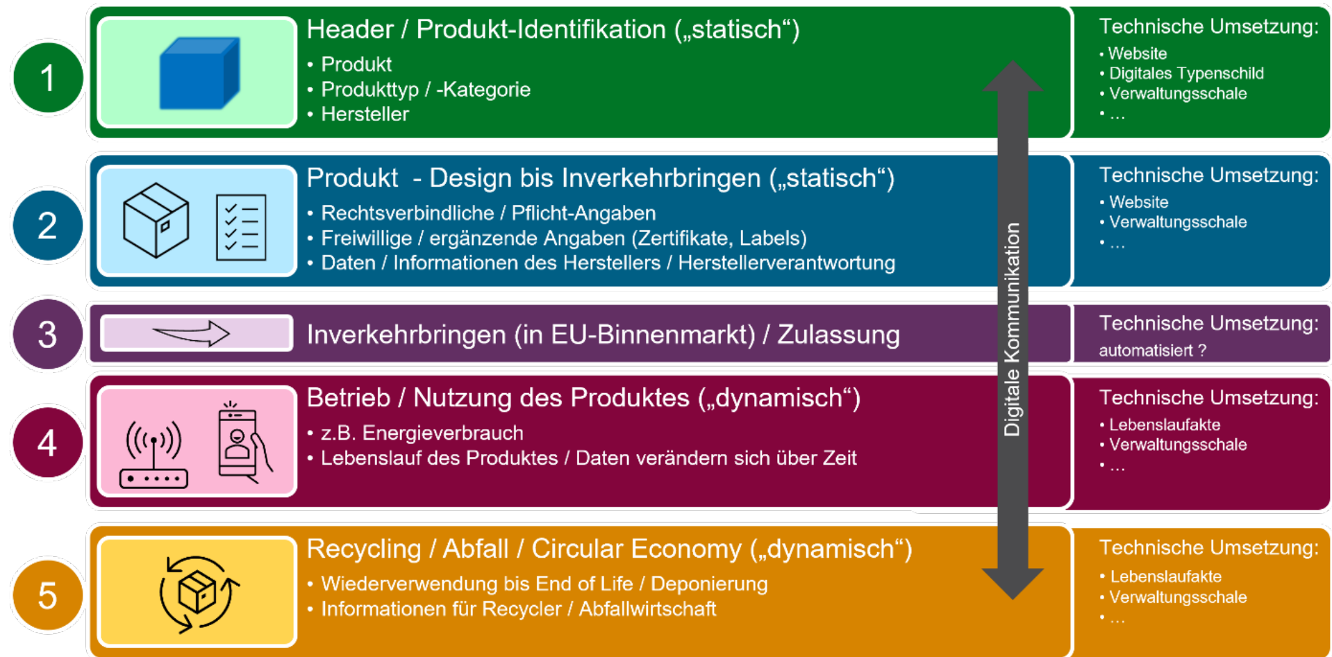
Abbildung 12: Struktur und technische Umsetzung des Umweltdatensets Produkt
