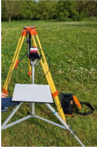
Abbildung 21: Kalibrierung mit Reflektionstarget
