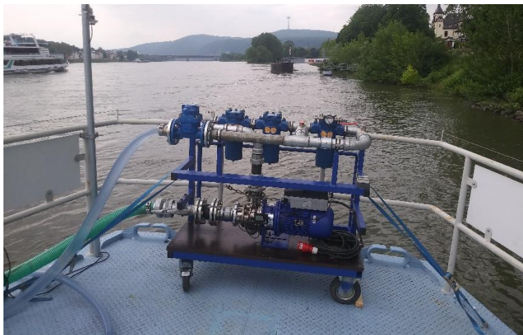
Abbildung 5: Die Filterkaskade im Einsatz am Steiger der BfG in Koblenz.
