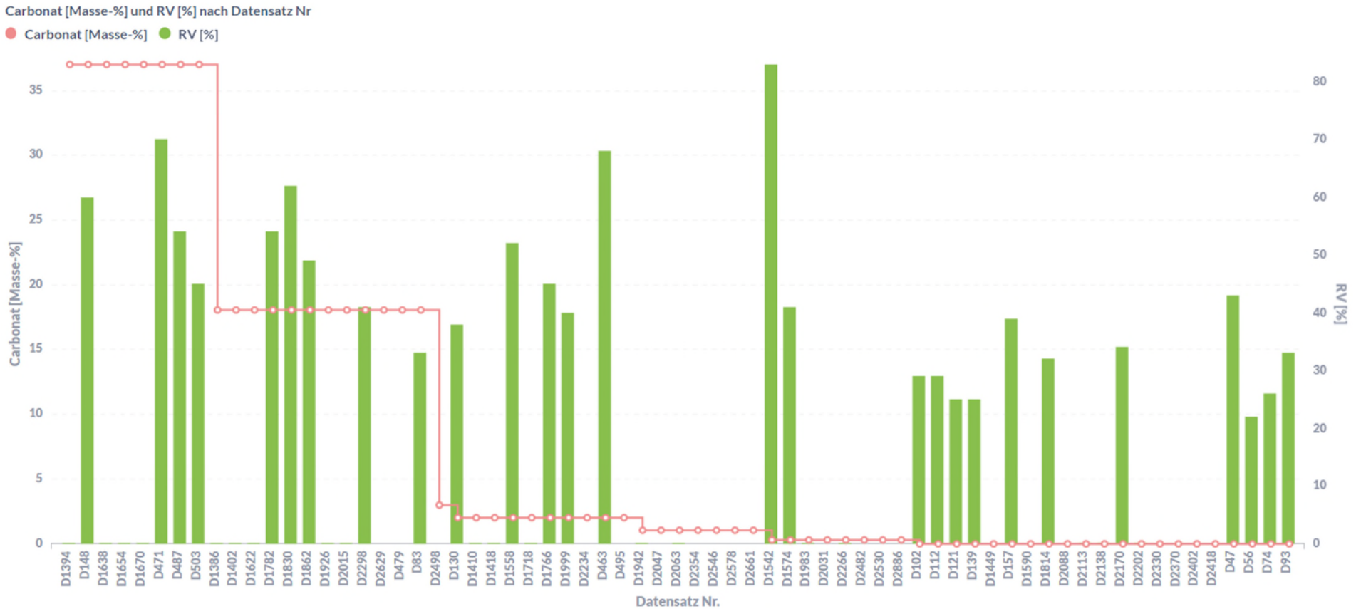
Abbildung 198: Dibenzo[a,h]anthracen – Datensätze Carbonat [Masse-%] und Resorptionsverfügbarkeit RV [%], Sortierung Carbonat absteigend
