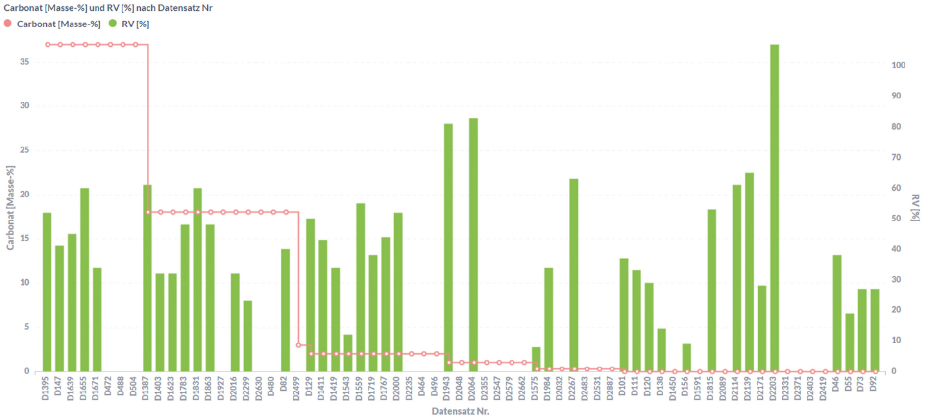
Abbildung 178: Benzo[ghi]perylen – Datensätze Carbonat [Masse-%] und Resorptionsverfügbarkeit RV [%], Sortierung Carbonat absteigend
