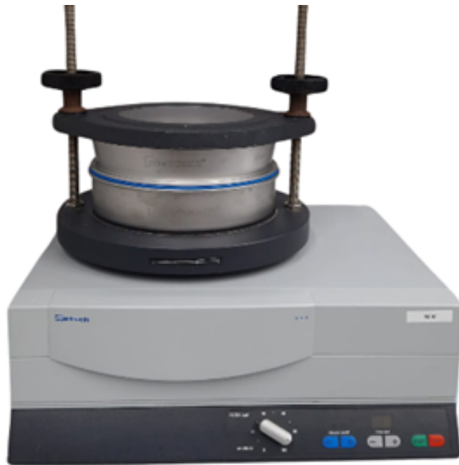
Abbildung 1: Darstellung der verwendeten Siebvibrationsmaschine und Analysensiebe
