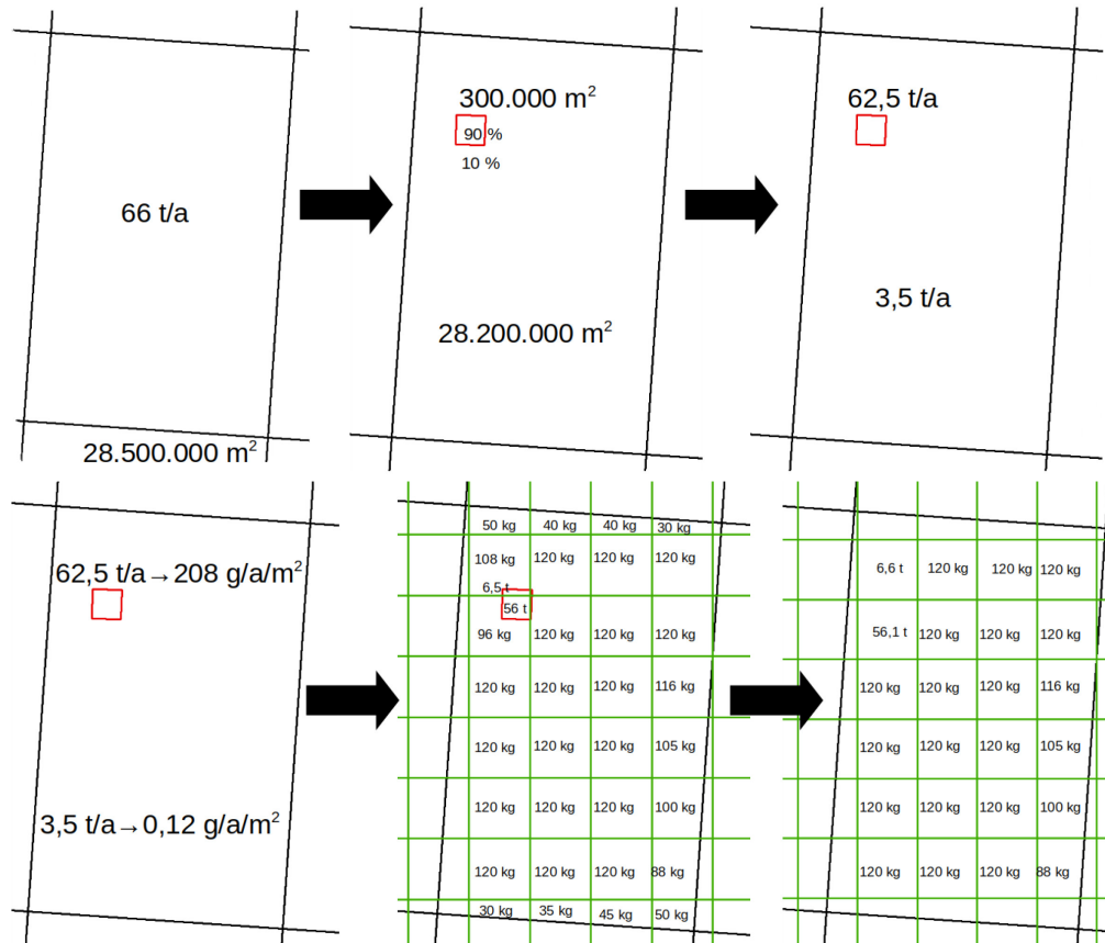
Abbildung 6: Schematische Darstellung des EEM-Präprozessors
