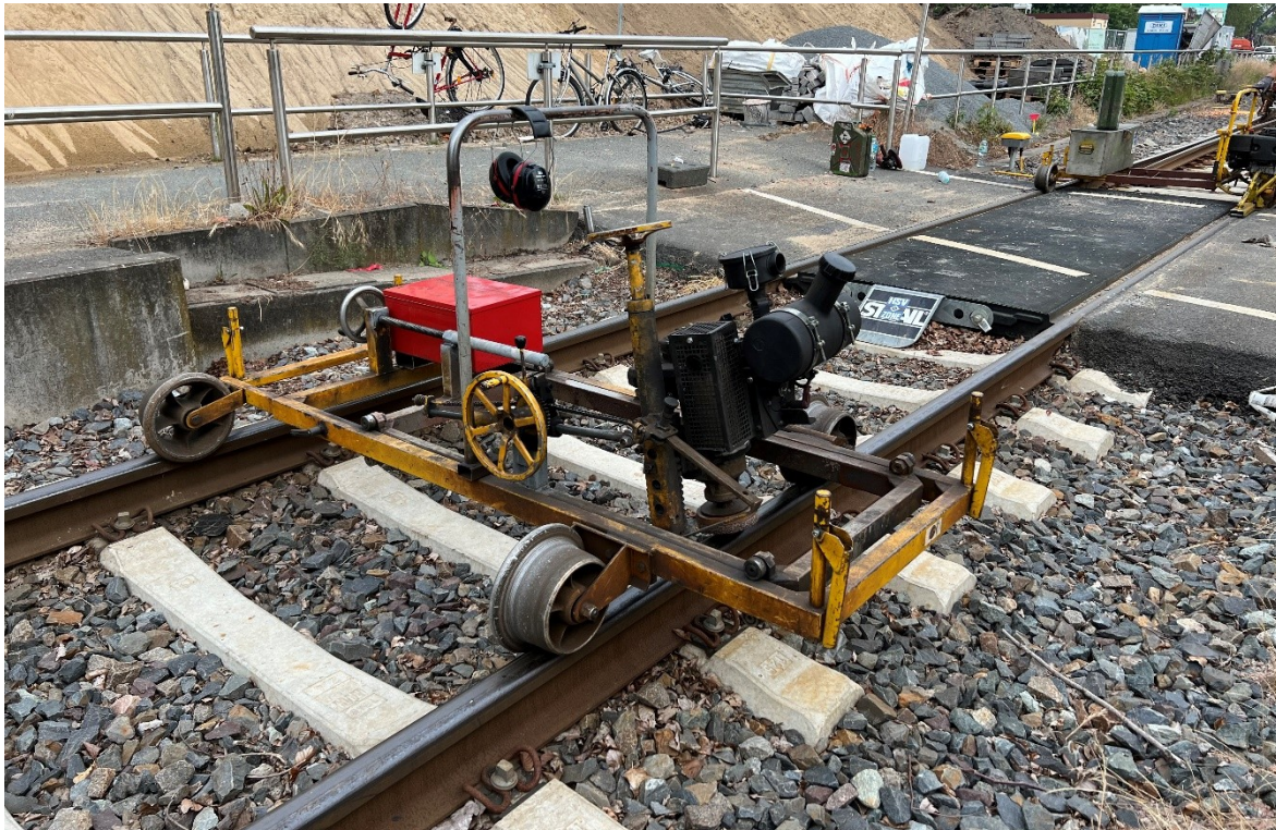
Abbildung 31: Ausführung einer Schienen- und Weichenschleifmaschine ohne Maßnahmen zur Schallminderung
