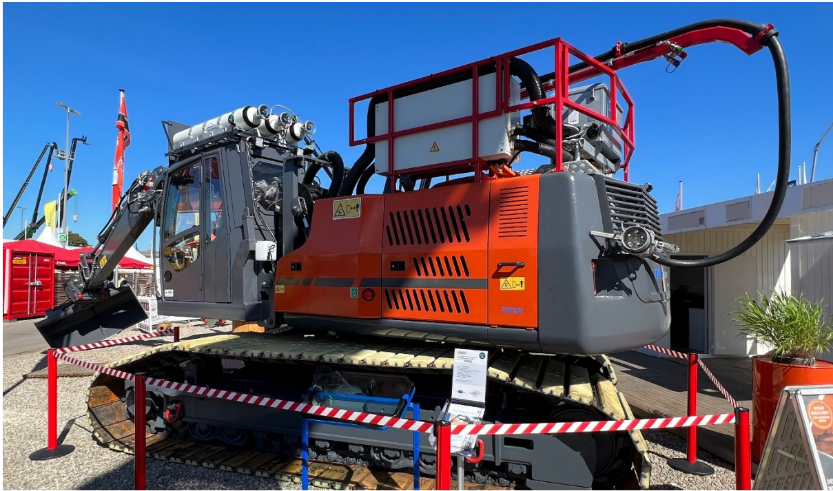
Abbildung 11: Vollelektrischer Kettenbagger mit kabelgebundener Stromversorgung
