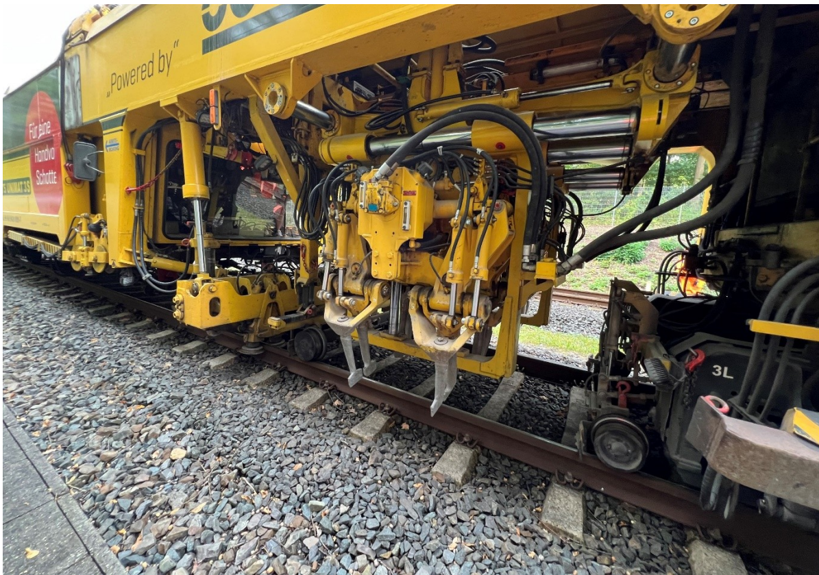
Abbildung 32: Schienengebundene Baumaschine zum Stopfen von Gleisen
