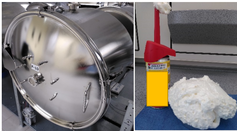
Abbildung 42: Emissionsprüfkammer und kommerzieller Polyurethanschaum für Emissionstest.
