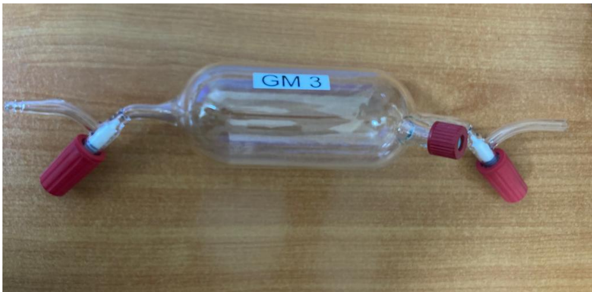
Abbildung 4: Beispiel für die im Projekt verwandten Gassammelgefäße (Gasmäuse).
