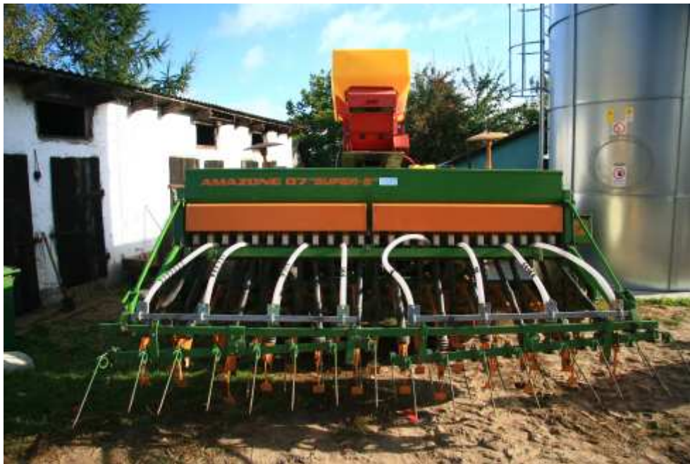
Die neue, moderne Drilltechnik, mit der computergesteuert z.B. Leindotter und Getreide gleichzeitig gesät werden kann
