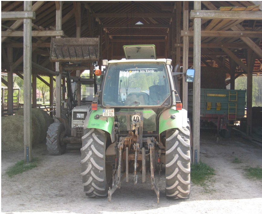
Dietmar Brand lebt vor, was er in Polen berät: Sein Deutz-Fahr ist umgerüstet auf den ausschließlichen Betrieb mit reinen Pflanzenölen
