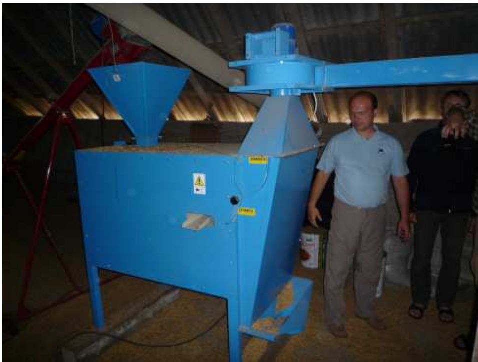
Die automatische Trennanlage kann Mischungen von bis zu 4 unterschiedlichen Korngrößen gleichzeitig separieren
