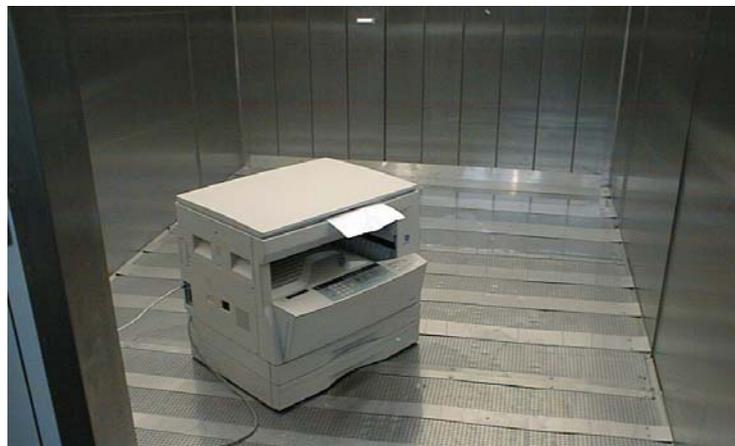
Abbildung K 2: Bild der 20 m<sup>3</sup>-Emissionsmesskammer, beladen mit einem untersuchten Kopierer
