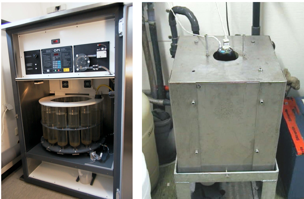
Abbildung 29 li.: Selbstentleerender Probenehmer (ORI), re.: Radioaktivitätserfassung in Hamburger Messstation
