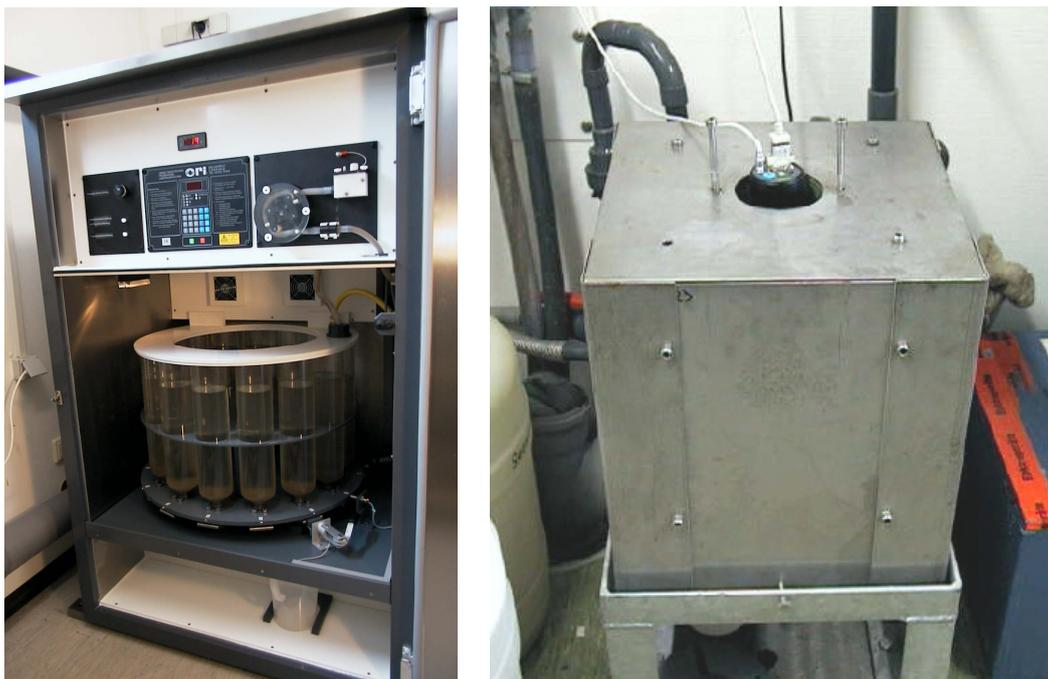
Abbildung 29 li.: Selbstentleerender Probenehmer (ORI), re.: Radioaktivitätserfassung in Hamburger Messstation
