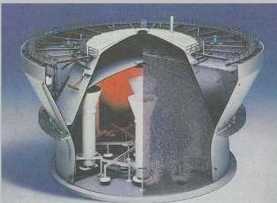
**Ilustración 33: Biorreactor alto (Krupp-Uhde) [15]**
