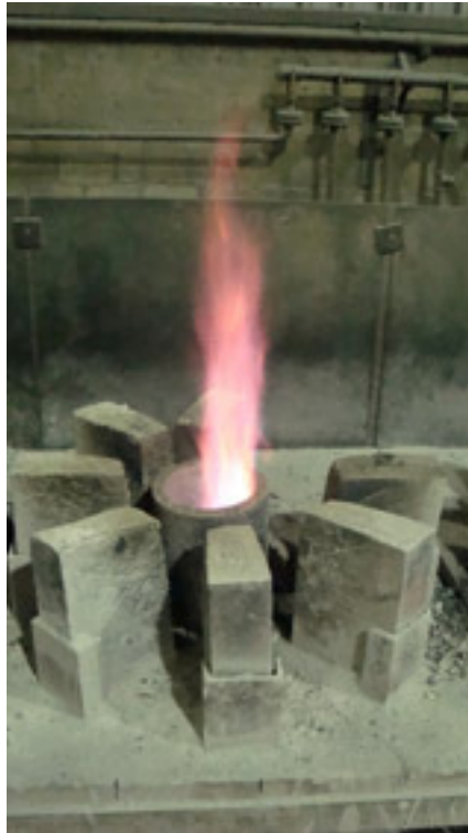
Abbildung 5: Pfannenbeheizungsstation mit Flammenwerfer
