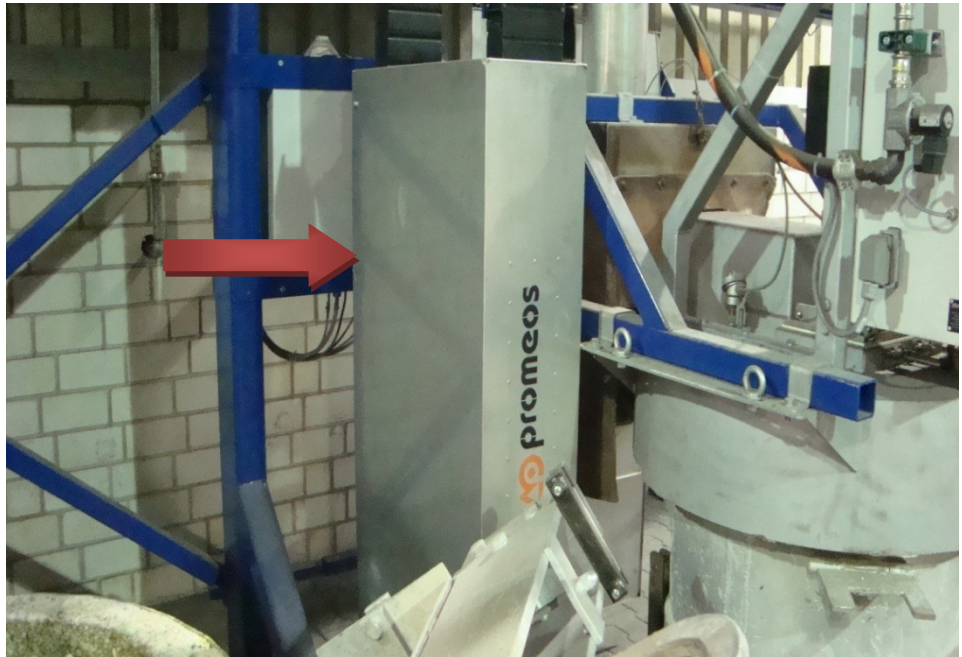
Abbildung 22: Anbau von „Kästen“ zum Hitzeschutz der Kabelschlepps
