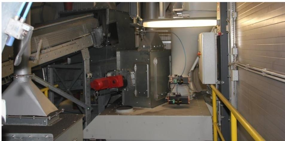
**Bild 2.9: Präzisions-Wiegesystem für den Altsand**
