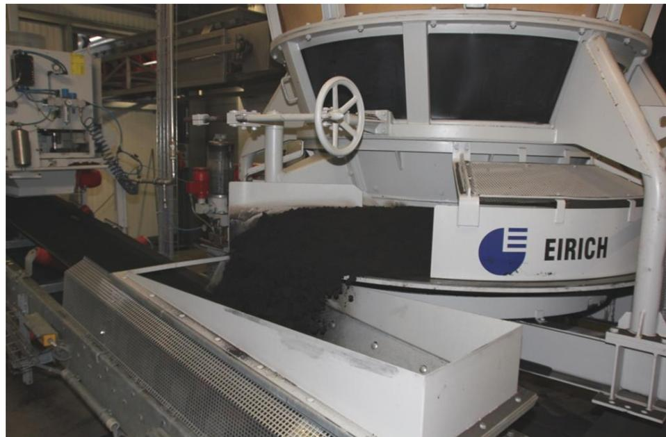
**Bild 2.12: Telleraufgeber: Fertigsandaufgabe auf den Bandförderer**
