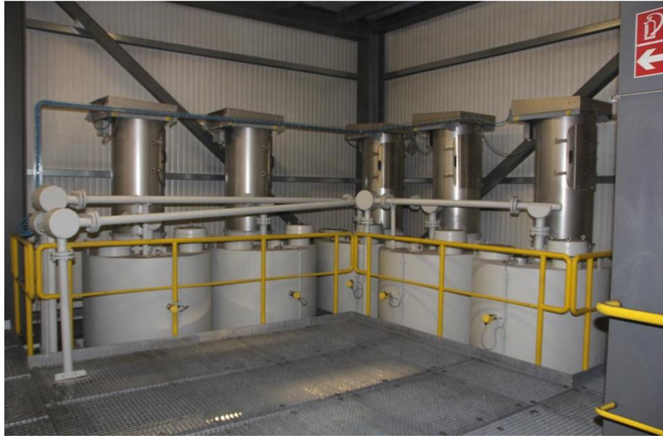
**Bild 2.8: Additivbunker für die Zugabe von 3 x Neusand, Filterstaub und Bentonit**
