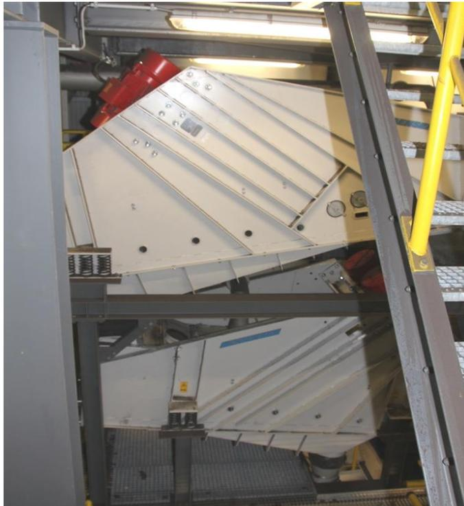
**Bild 2.6 a: Flachsiebe mit unterschiedlicher Maschenweite**
