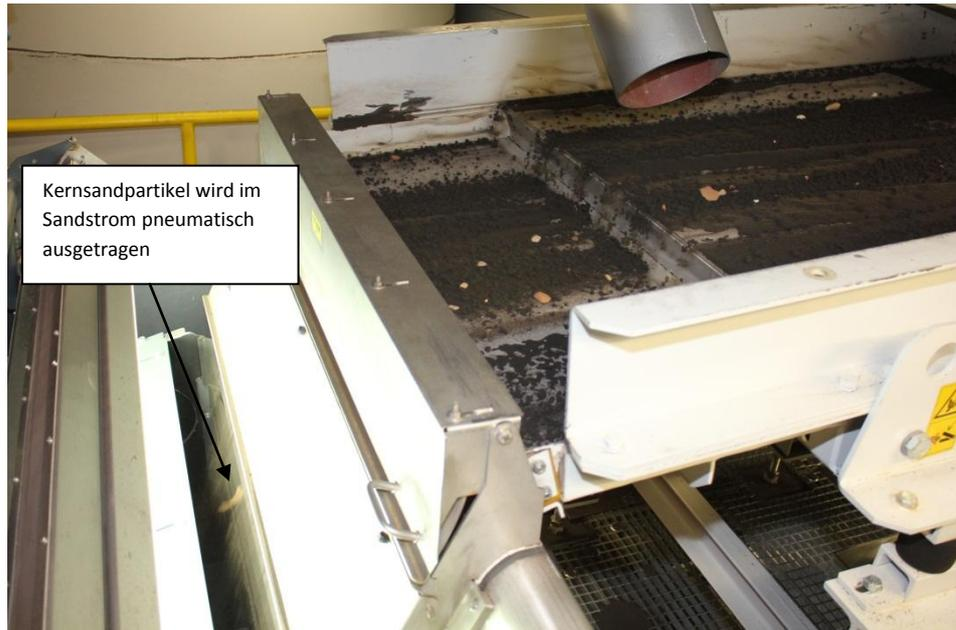
**Bild 2.6b: MicroSort-Anlage: Blick in das geöffnete Aggregat**
