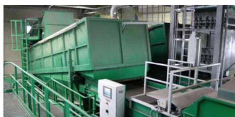
**Abbildung 3.1.17 ballistischer Separator; Foto: Komptech**
