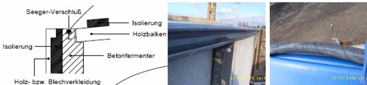
**Abbildung 3.3.4 Systeme zur Foliendachdichtung; Links: Seeger-Verschluß mit Schiene in Behälterwand; Mitte: Außenklemmschiene; Rechts: Anbringen eines Pressluftschlauches an Außenklemmschiene; Fotos: Biogashandbuch Bayern (links)**
