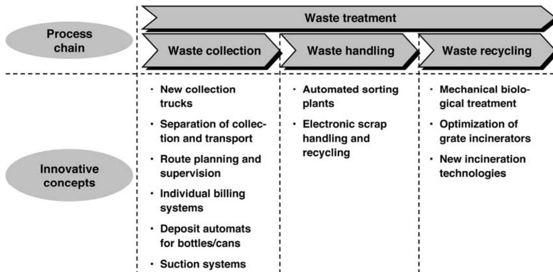
Automatisierte Stofferkennungs- und -trennverfahren lassen den Prozess der Abfallbehandlung weniger personalintensiv werden (Kostenreduktion) und ermöglichen darüber hinaus eine bessere und sauberere Trennung der einzelnen Abfallfraktionen (= potenzielle Sekundärrohstoffe). Optimierte Logistik (z. B. Sammelsysteme, Routenplanung) sowie Technologien zur Emissionsreduzierung (z. B. für Luftschadstoffe oder Deponiesickerwasser) werden jedoch auch mit großen Einspar- und Exportpotenzialen verknüpft.
