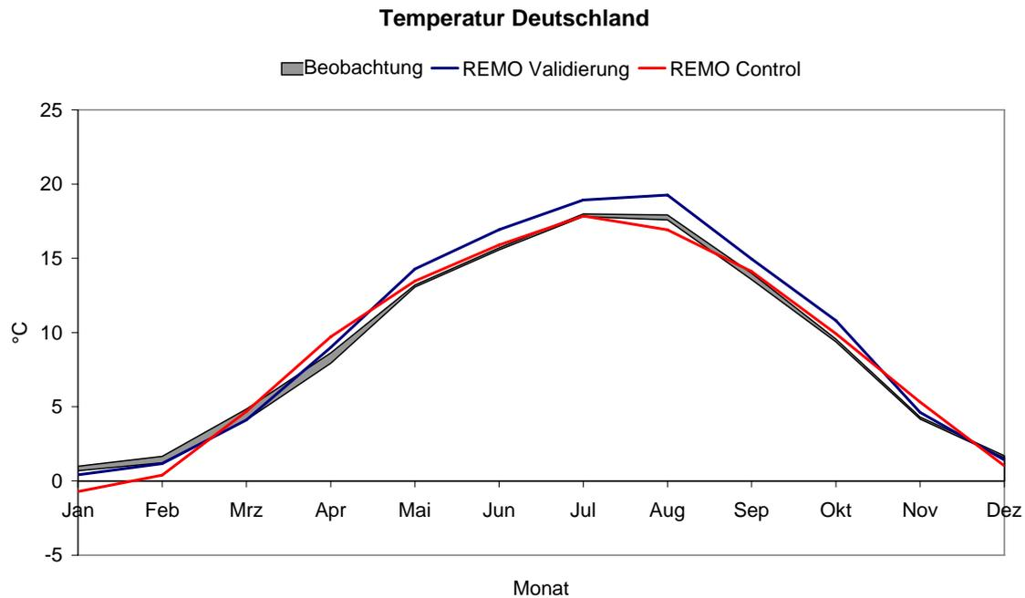
**Abb. 25:** Mittlerer Jahrgang des Gebietsmittels der 2m-Temperatur für Deutschland [°C] aus dem Validierungslauf (blau) sowie dem Kontrolllauf (rot) im Vergleich zu Beobachtungen (grauer Bereich – von CRU und ERA40 aufgespannter Bereich) für den Zeitraum 1960 - 2000.
