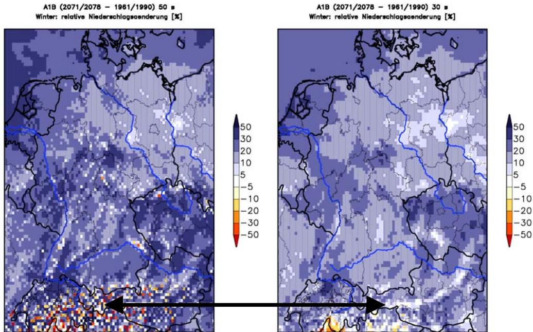
Abb. 6: Relatives Niederschlagsänderungssignal [%] des Zeitraums 2071-2078 in Bezug auf den Referenzzeitraum 1961-1990: links REMO Simulation mit einem Zeitschritt von 50 s für 2071-2078, rechts mit einem Zeitschritt von 30 s. Der Referenzzeitraum (1961-1990) wurde jeweils mit einem Zeitschritt von 30 s gerechnet.
