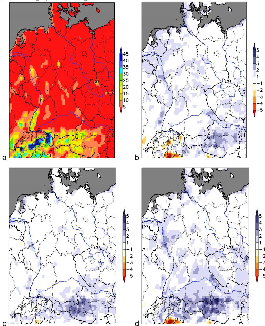
Abb. 71: Kartendarstellung der Anzahl der „Nassen Tage“<sup>7</sup> pro Jahr für den Zeitraum 1961-1990 (KNP) (a), sowie die Änderung dieser Größe für die Zukunftsperiode von 2071-2100 gegenüber der KNP von 1961-1990 für b) das A1B Szenario, c) das B1 Szenario und d) das A2 Szenario. Gitterboxen mit einem Wasseranteil über 50 % sind grau ausmaskiert. Die Darstellung erfolgte mit einem 9-Punktefilter.
