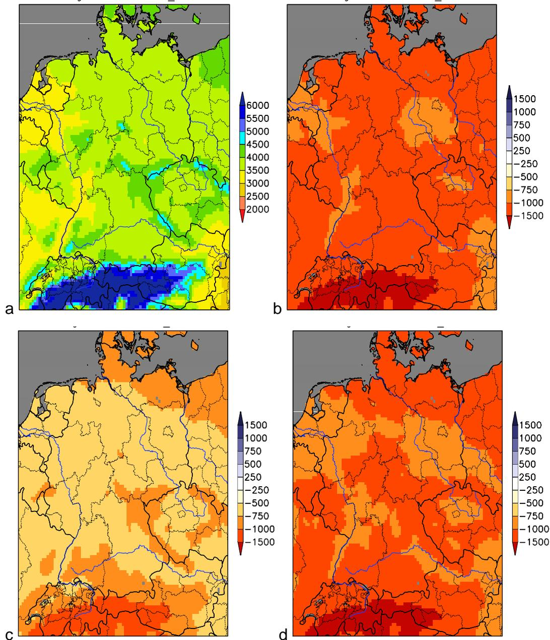
Abb. 74: Kartendarstellung der Gradtagszahl<sup>8</sup> für den Zeitraum 1961-1990 (KNP) (a), sowie die Änderung dieser Größe für die Zukunftsperiode von 2071-2100 gegenüber der KNP von 1961-1990 für b) das A1B Szenario, c) das B1 Szenario und d) das A2 Szenario. Gitterboxen mit einem Wasseranteil über 50 % sind grau ausmaskiert.
