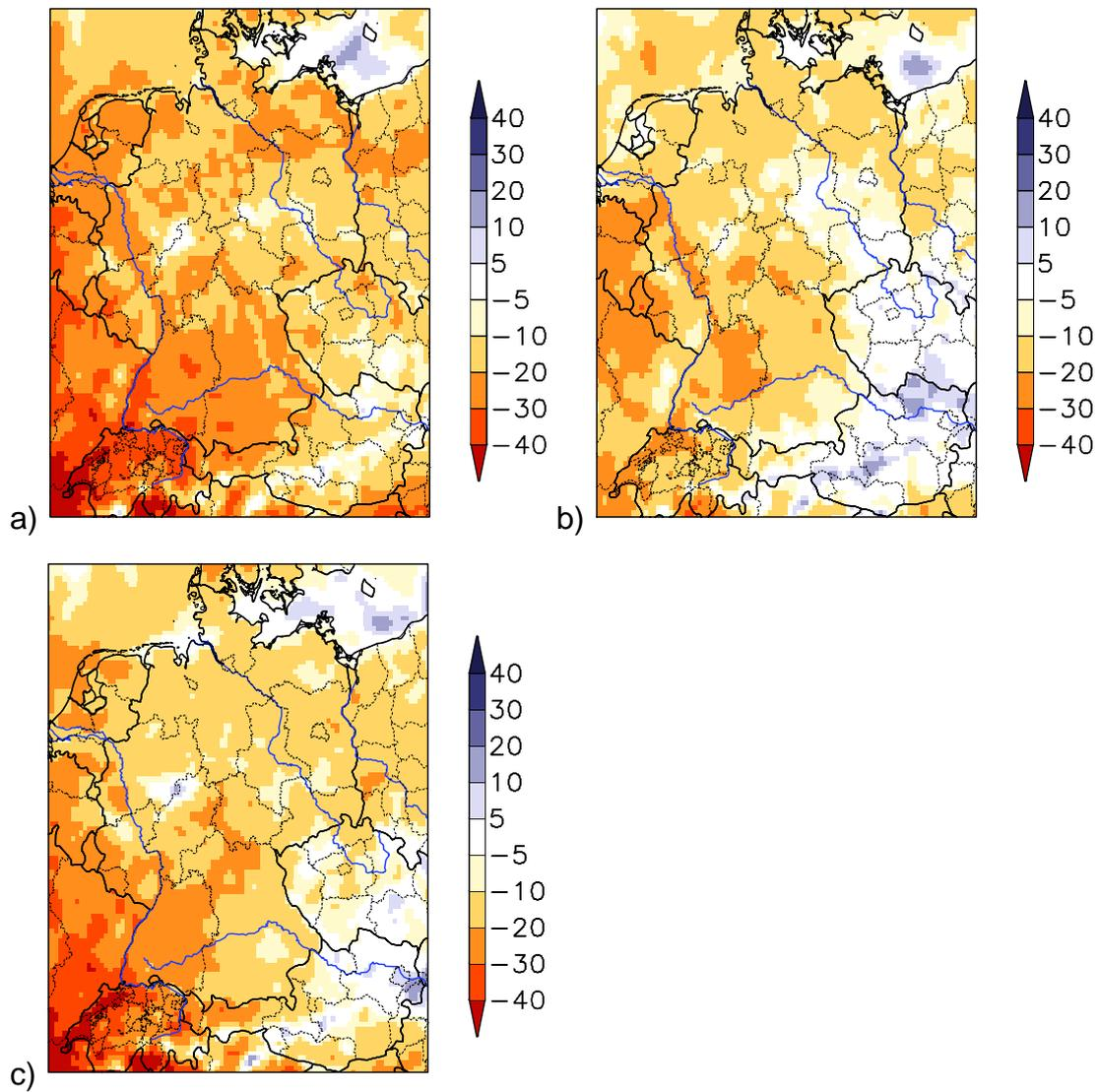
**Abb. 66:** Kartendarstellung der mittleren relativen Niederschlagsänderung [%] im Sommer für die Zukunftsperiode von 2071-2100 gegenüber der KNP von 1961-1990 für a) das A1B Szenario, b) das B1 Szenario und c) das A2 Szenario. Die Darstellung erfolgte mit einem 9-Punktefilter.
