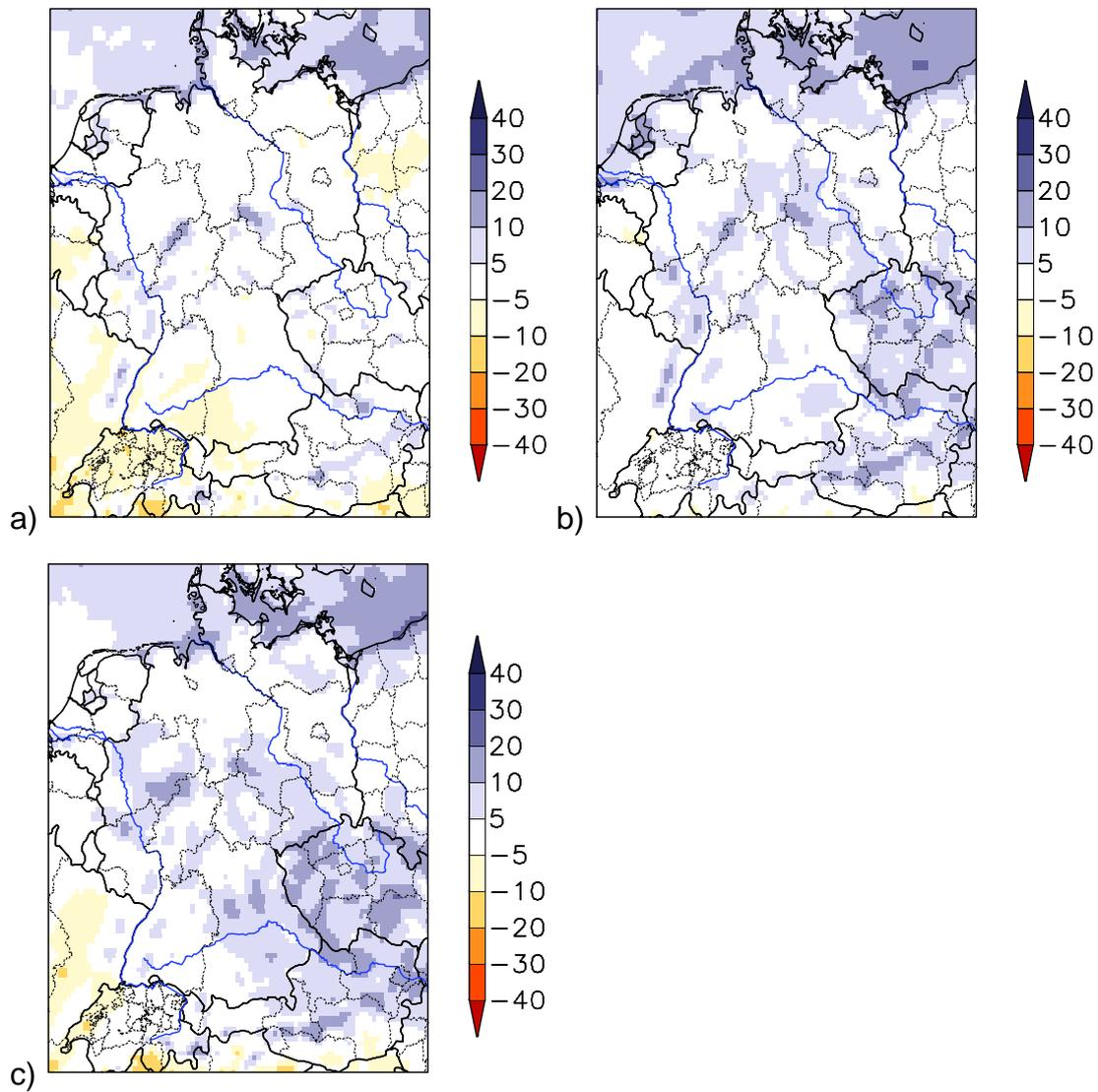
**Abb. 64:** Kartendarstellung der mittleren relativen Jahresniederschlagsänderung [%] für die Zukunftsperiode von 2071-2100 gegenüber der KNP von 1961-1990 für a) das A1B Szenario, b) das B1 Szenario und c) das A2 Szenario. Die Darstellung erfolgte mit einem 9-Punktefilter.
