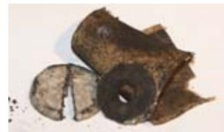
Abb. 4: Mechanisches Zerlegen von Rundzellen (Zink-Kohle)
