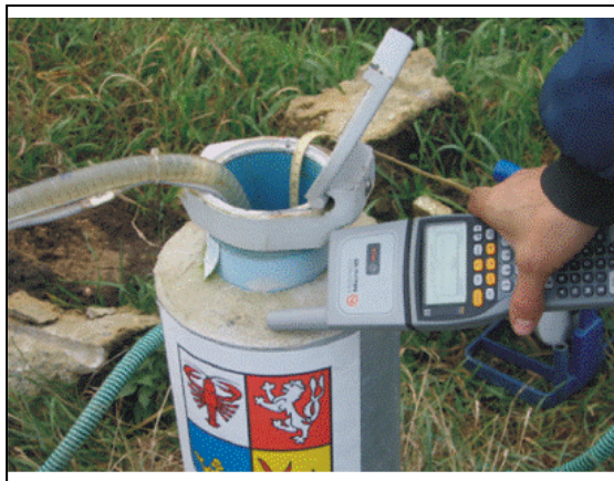
Bild 6 und 7 Anbringung von Transpondern im Betonschutzring und am Unterflurausbau
