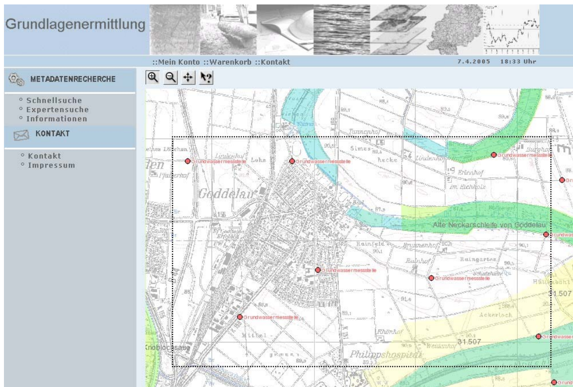
Abbildung 4: Geodaten-Recherche auf Basis der Metadaten; räumliche Suche von Grundwasser-Informationen mittels der Web-GIS-Komponente (UMN Mapserver)
