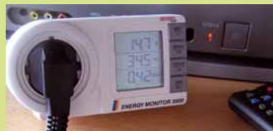
Ein Energie-Monitor macht versteckte Leerlaufverluste sichtbar.
