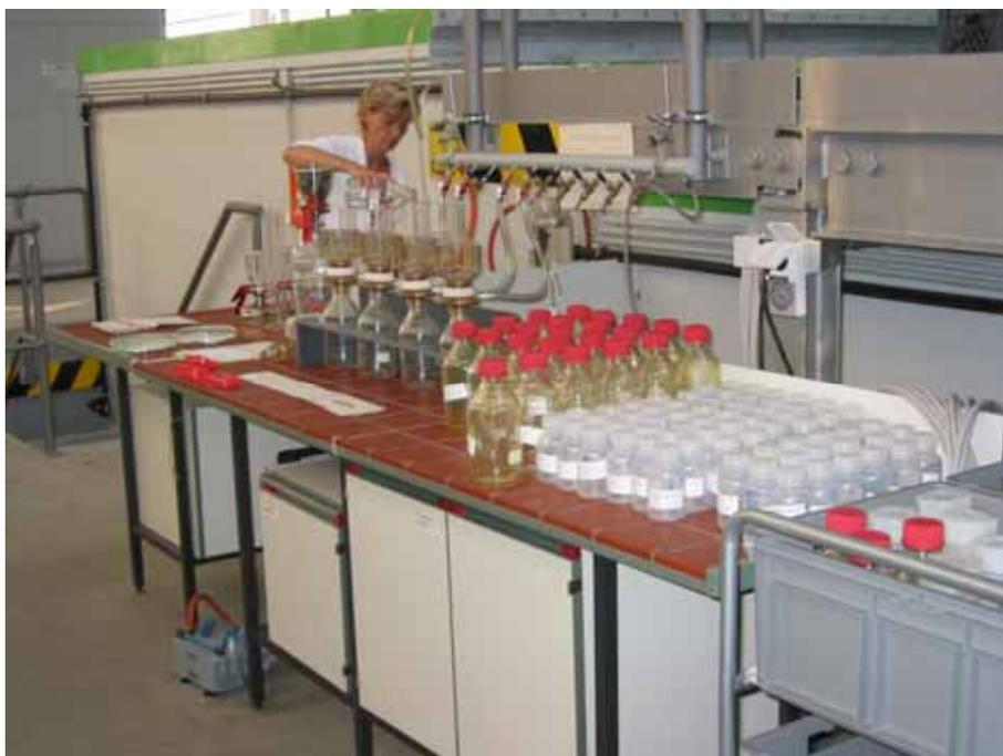
Abb. 17: Filtrationsanlage zur Wasserprobenaufbereitung
