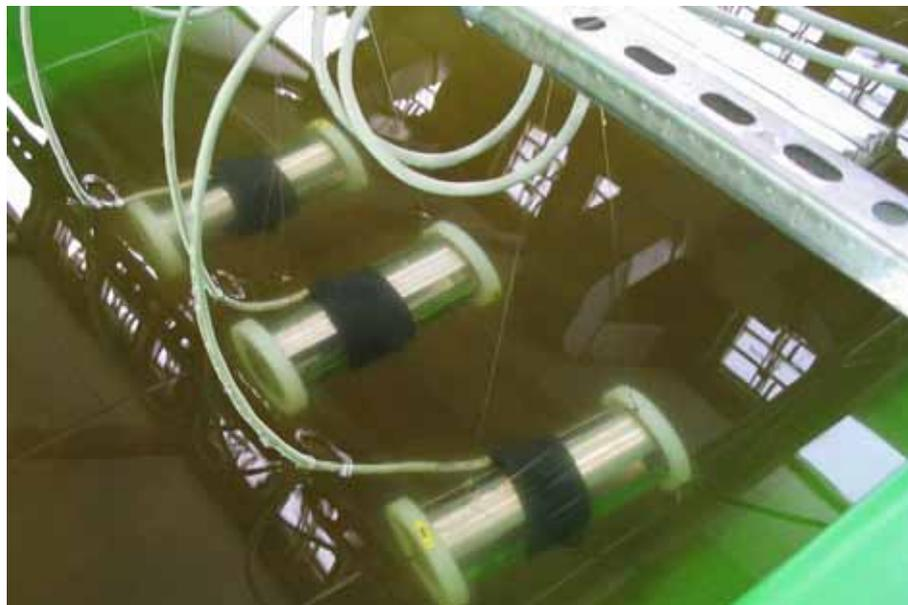
Abb. 21: Messkammern des Multispecies Freshwater Biomonitor in einer Rinne
