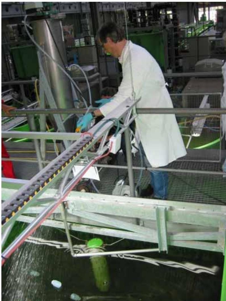
Abb. 8: Applikation von Metazachlor in den Teichen mit einem mobilen Edelstahlmischbehälter
