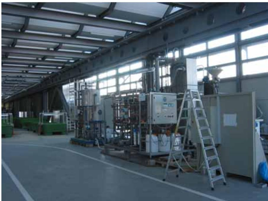
Abb. 32: Pilot-Mikrofiltrationsanlage in der FSA-Halle
