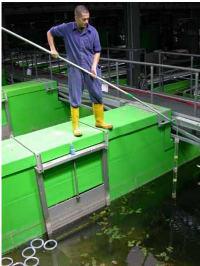
Abb. 19: Zooplanktonprobennahme mit speziellem Planktonplexiglasrohr
