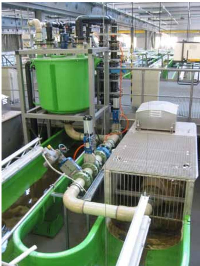
Abb. 9: Applikation von Metazachlor in den Rinnen mit den fest installierten Mischbehältern
