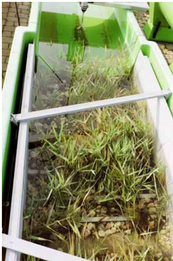
Abb. 87: Holzverschalung, eingesetzte Rohrglanzgrasmatten und Sedimentfallen (Quelle: Autoren)
