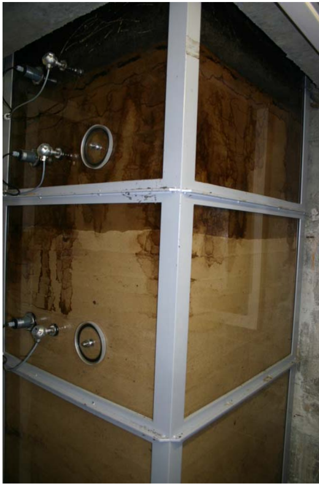
Abb. 4: Lysimeter befüllt mit Finowtaler Sandbraunerde
