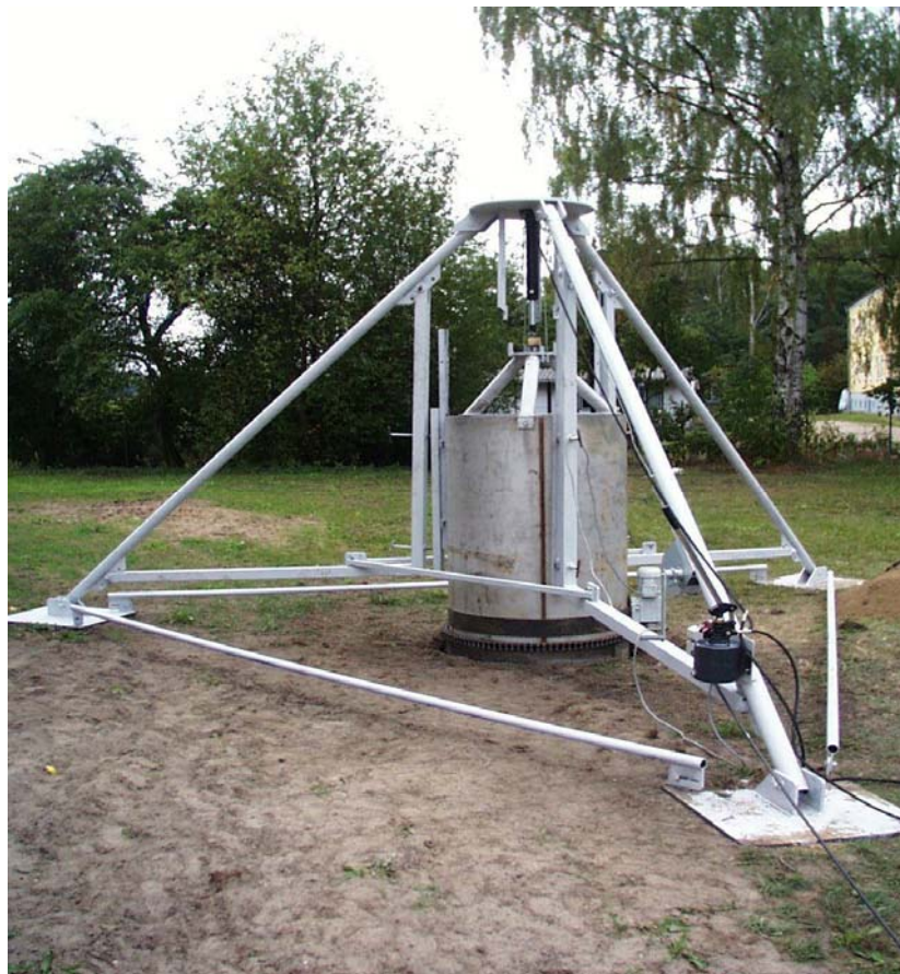
Abb. 3: Vorrichtung zur ungestörten vertikalen Entnahme von großvolumigen Bodenmonolithen
