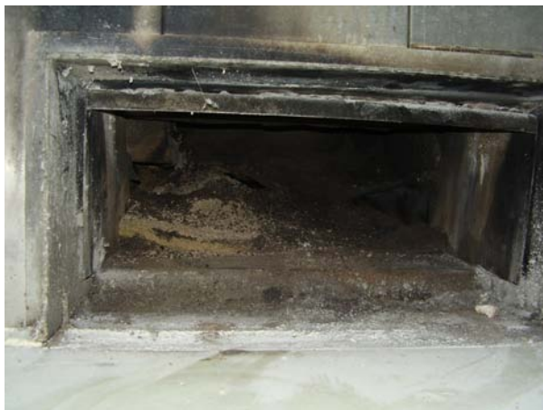
Abb. 10 Ascheausbringung des Etagenofens
