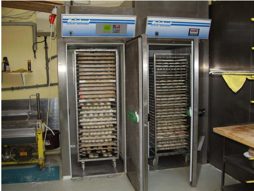
Abb. 12 Gärautomat (links) und Gärunterbrecher (rechts) mit Stikkenwagen und vorgefertigten Teiglingen
