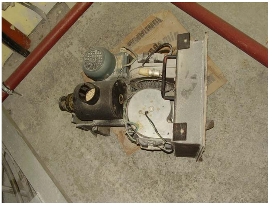
Abb. 8 Ausgebauter Pelletbrenner, wie er in den Backöfen installiert wurde
