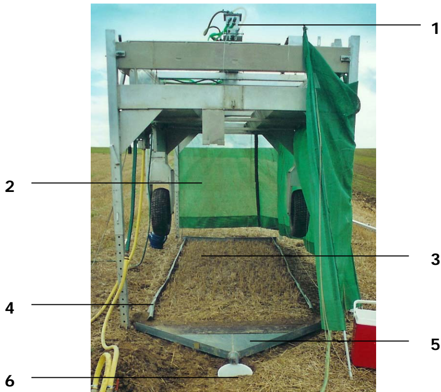
1: Beregnungsschwenkkopf, 2: Windschutz, 3: Testplot, 4: Leitbleche, 5: Abflußrinne, 6: Runoff-Sammler
