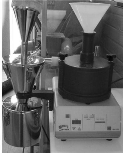
Abbildung 23: Zentrifugalmühle, Fa. Retsch ZM 1000.
