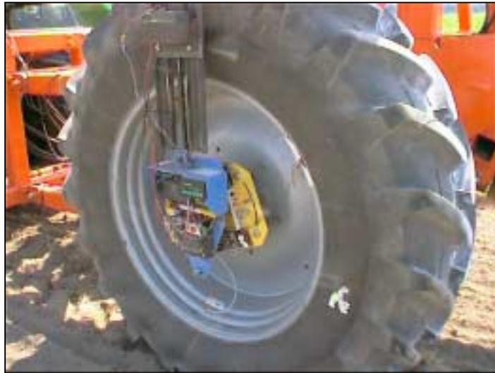
**Abbildung 19:** Sensorik an der Einzelradmessvorrichtung der FAL zur Ermittlung von Radumdrehung und Reifenverformung.
