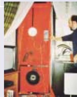
Messung der Luftdichtheit mit Hilfe einer „Blower Door“ in einer bewohnten Wohnung.
