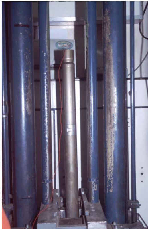
Abb. 13. Drucksonde FROSTAP 35: Sonde im Einsatz – Vortrieb des Gestänges (Foto: I. Stodian).
