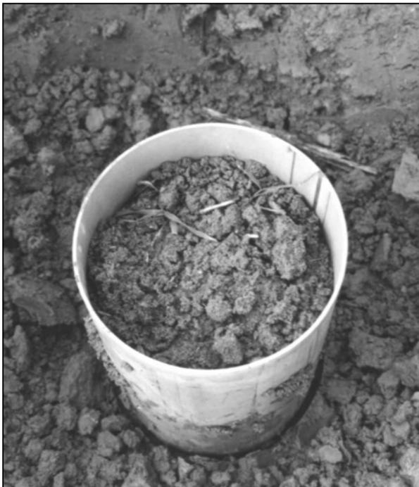
**Abbildung 31: Aufsicht auf eine Bodensäule bei der Feldprobennahme**
