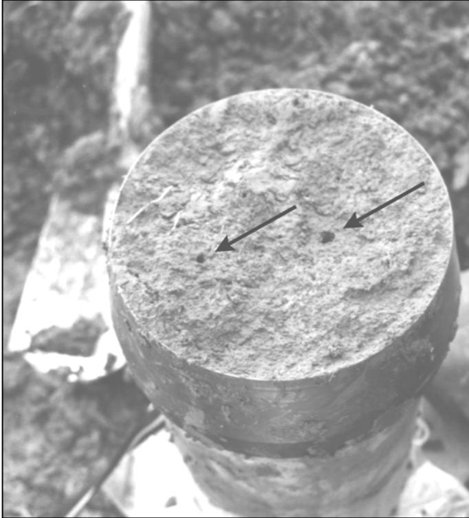
**Abbildung 32: Sekundärstruktur am unteren Rand der Oberbodensäulen nach Entnahme aus dem Feld (Standort Oberndorf)**
