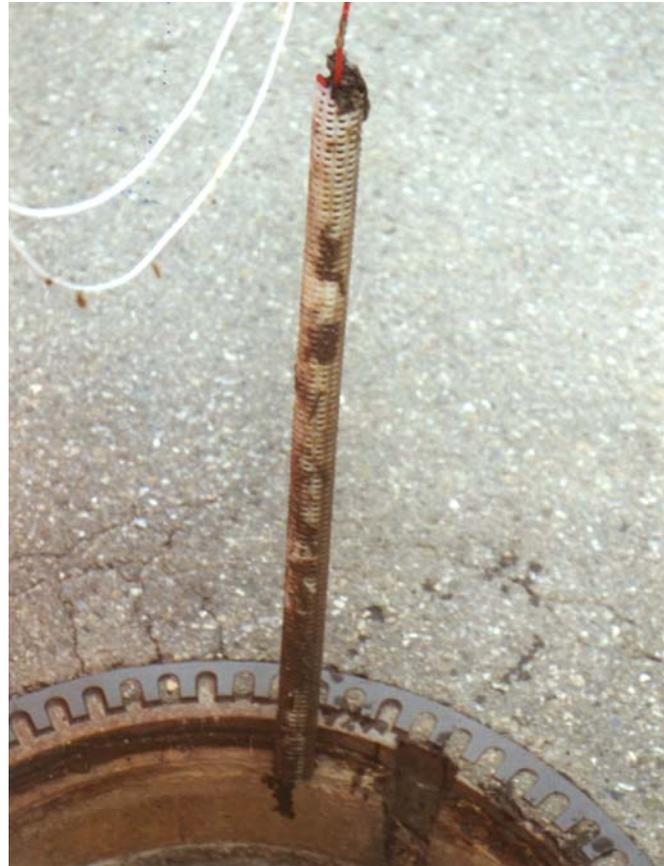
**Abbildung 25: SAF-Körper nach der Entnahme aus dem Kanalnetz**
