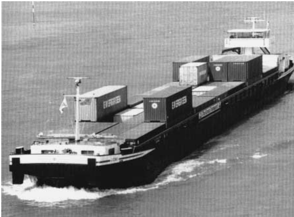
Abb. 39: Container-Motorschiff mit 4-reihiger Containerstauung (Breite ca. 12 m)
