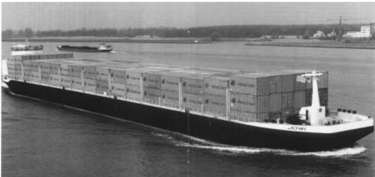
Abb. 45.a: MS „JOWI“, derzeit größtes Container-Motorschiff (mit Container-Führungszellen – Einsatz auf dem Rhein)
