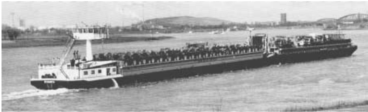
Abb. 38.a: Koppelverband (Ro/Ro-Motorschiff und Ro/Ro-Leichter)
