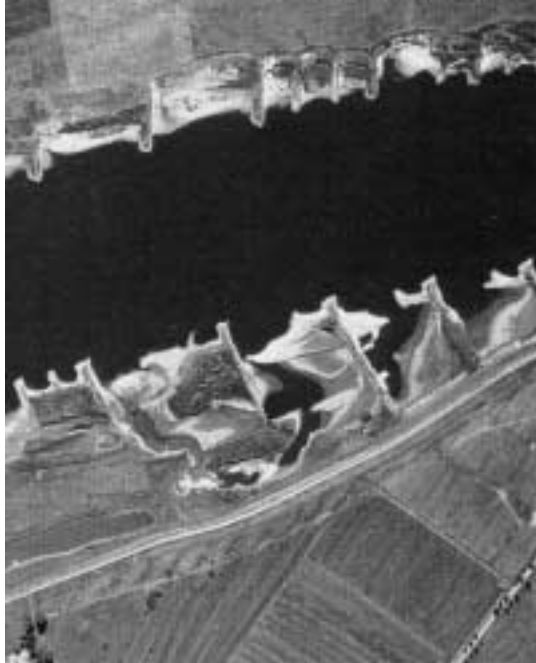
Abb. 9: Deutlich ausgebildete Bunnenfeldstrukturen in Abhängigkeit von Luv- und Lee-seite (Luftbildausschnitt WSD Ost 1992)
