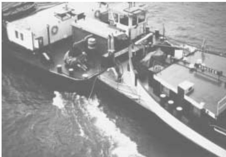
Abb. 38.b: Koppelverband / Details der Längs-Kopplungstechnik
