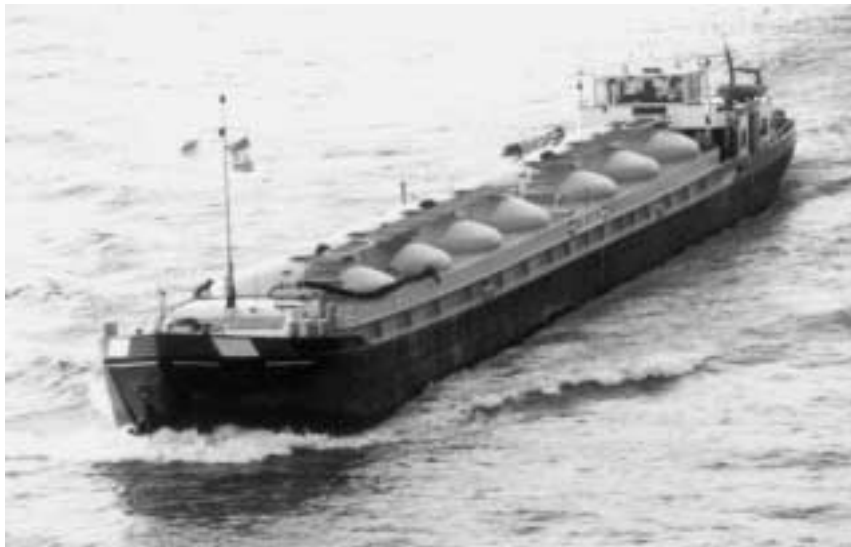
Abb. 48: Silo-Motorschiff (für trockene Schüttgüter)
