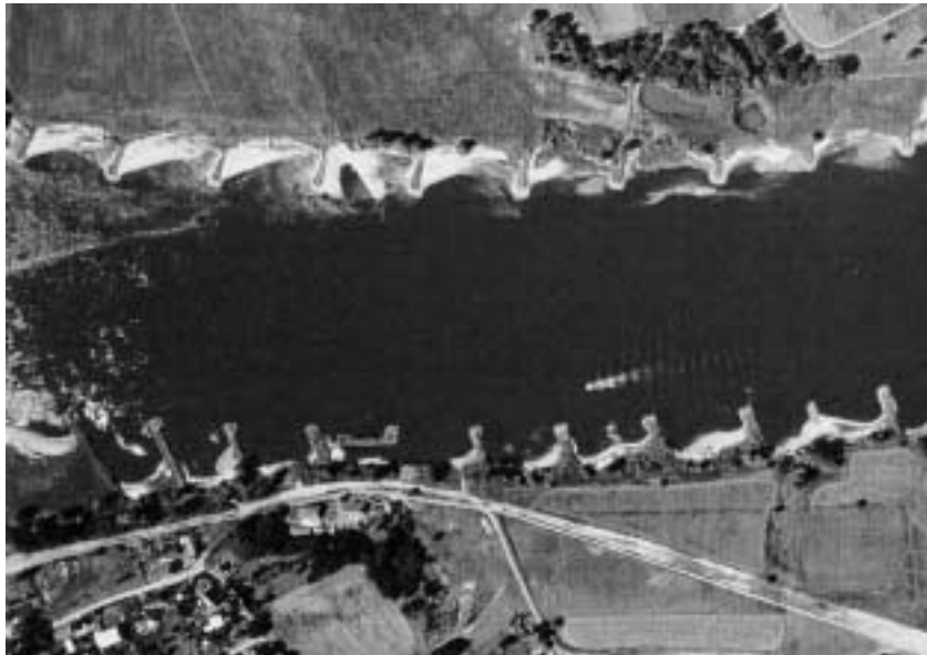
Abb. 6: Elbe im Bereich Fluss-km 511 (Luftbildausschnitt WSD Ost 1992); reich strukturierte Buhnenfelder
