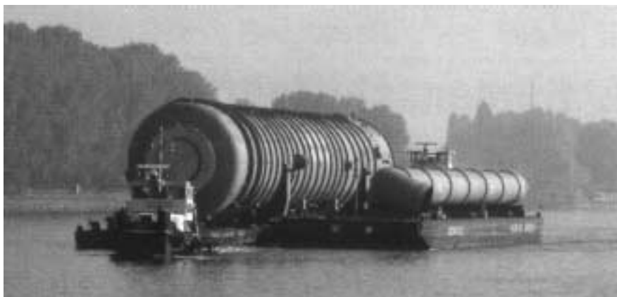
Abb. 47: Schubverband mit Glatdecks-Ro/Ro-Schubeinheiten (beladen mit Schwergut)
