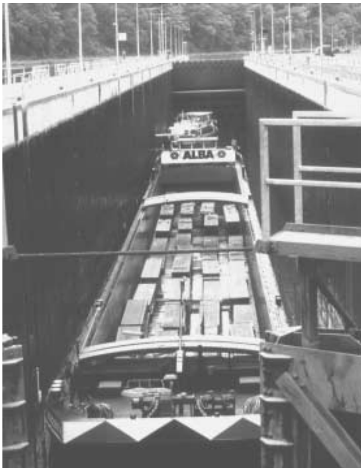
Abb. 43: Trocken-Motorgüterschiff in Doppelhüllen-Bauweise (beladen mit Stahlhalbzeug)
