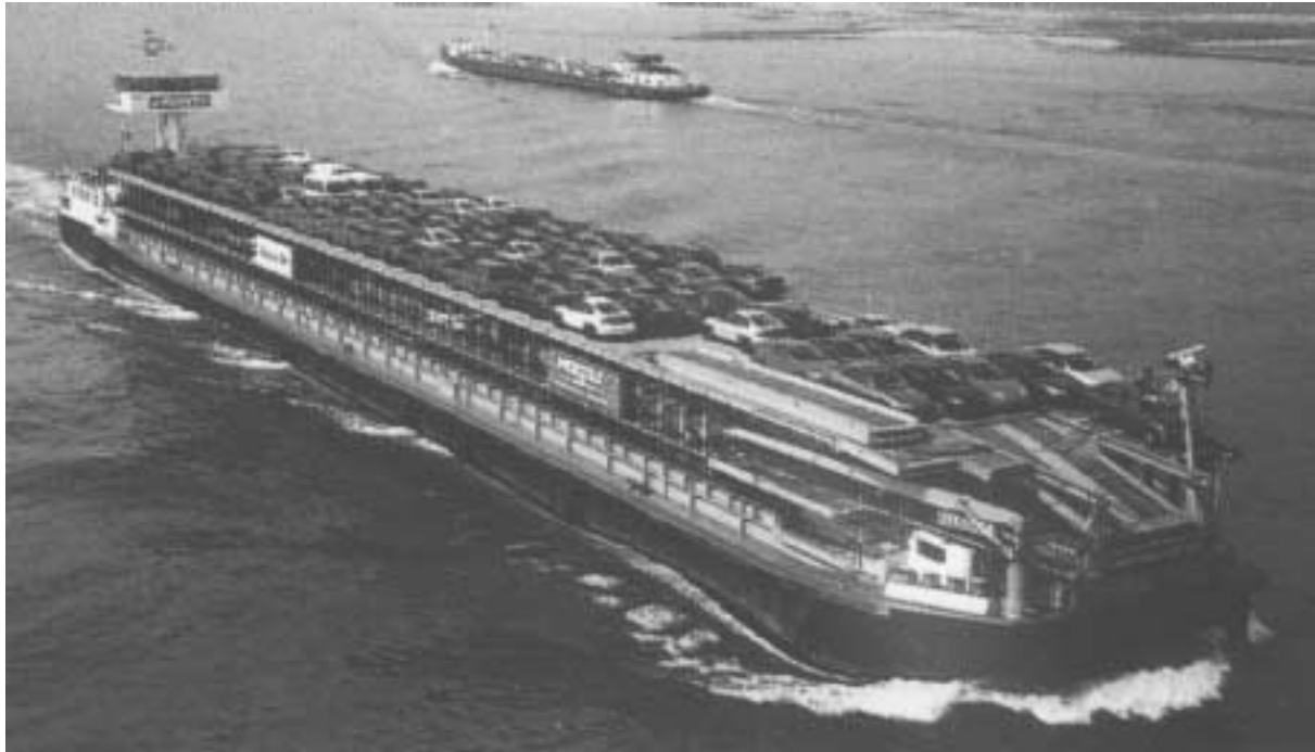
Abb. 40: Ro/Ro-Motorschiff mit 3 Decks (PKW-Stauung)
