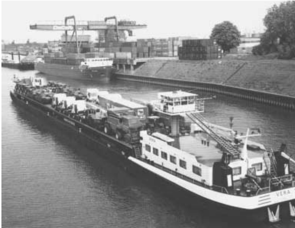
Abb. 46: Ro/Ro-Motorschiff (beladen mit unterschiedlichen rollenden Ladungseinheiten)
