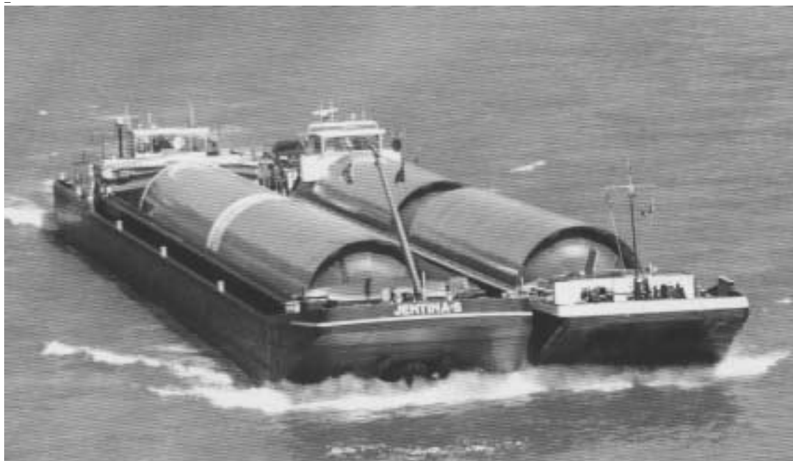
Abb. 32.b: Trocken-Motorgüterschiffe (beladen mit Schwergütern, gekoppelt fahrend)
