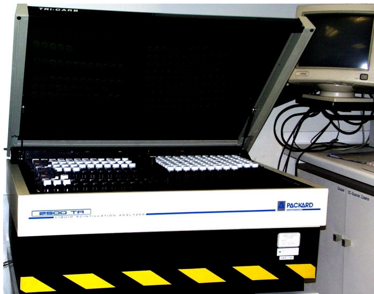
Abb. 6: TriCarb 2500 TR Flüssig-Szintillationszähler (Packard)
