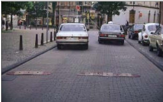
Bild 3.18: Stark dämpfende Metallschwelle
