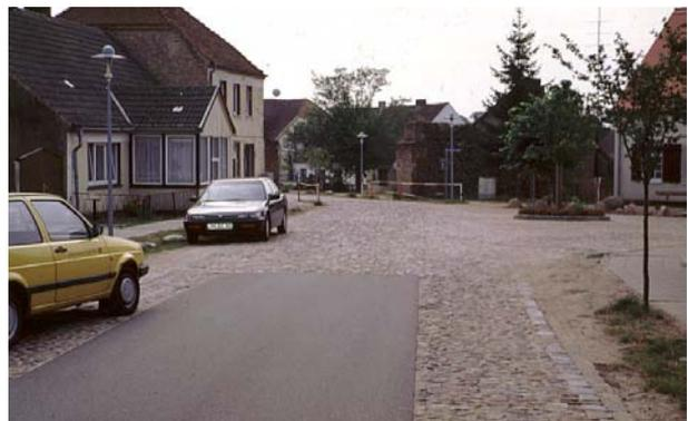
Bild 4.9: Falsch eingesetzter Pflasterbelag
