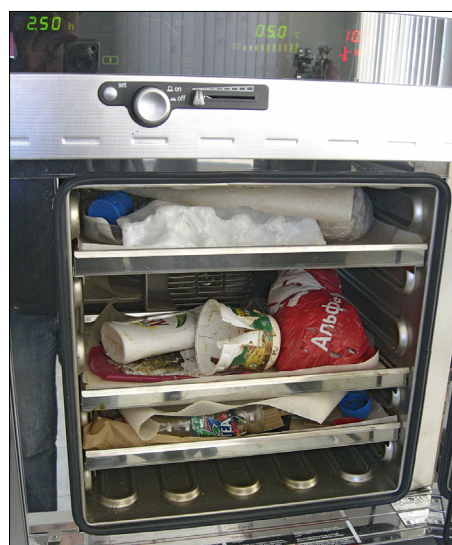
Определение содержания воды: Сушка пластика в сушильной печи
