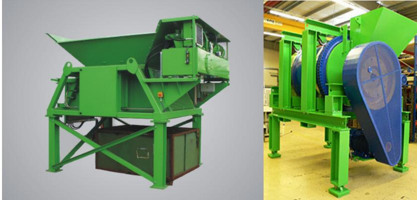
Abbildung 13: Aggregate zur mechanischen Vorzerlegung (Quelle: BRT, MEWA)
