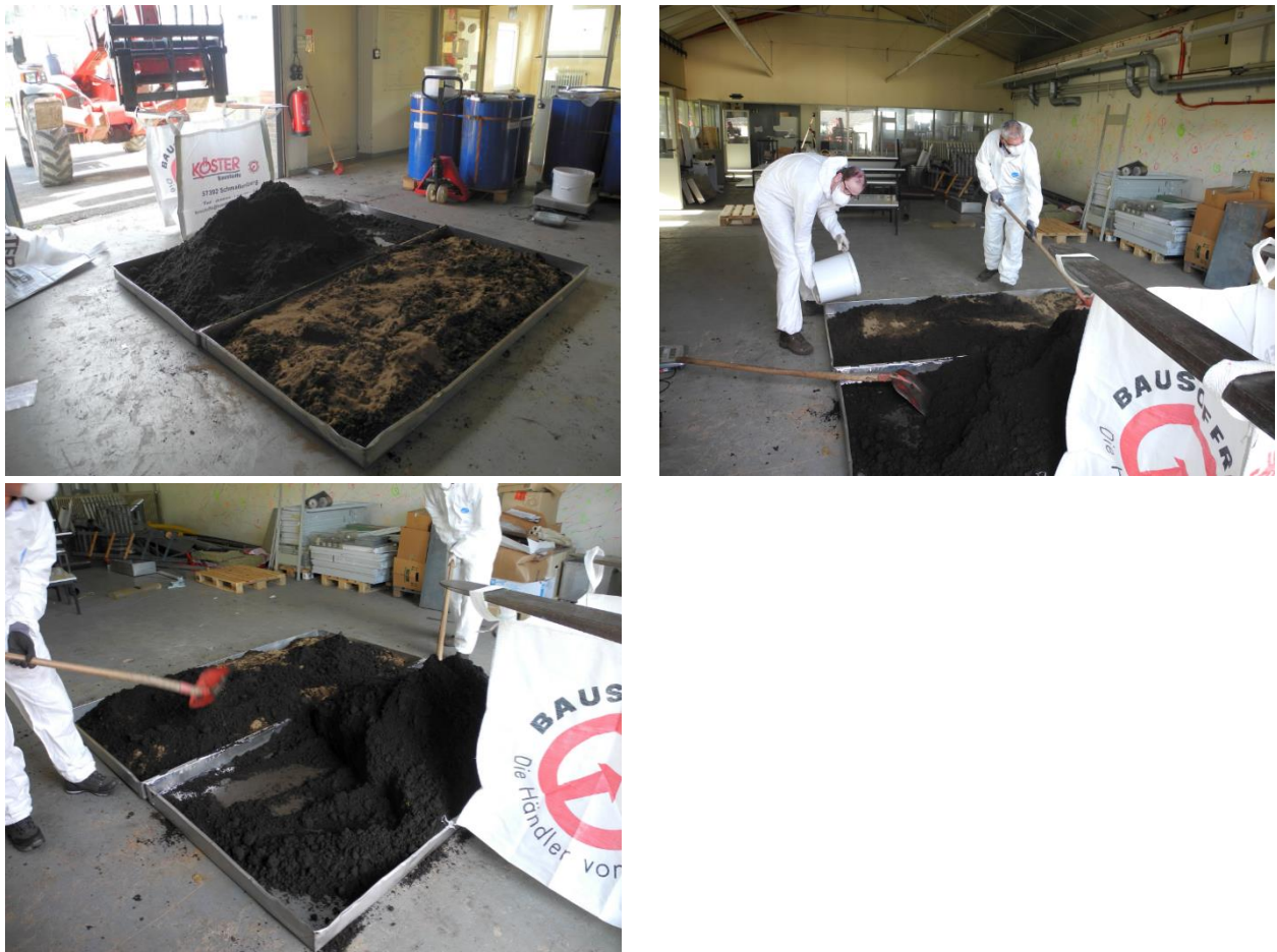
Herstellung des Gemisches aus Boden (RefeSol 04-A) und Klärschlammasche (eigene Darstellung, Fraunhofer IME).
