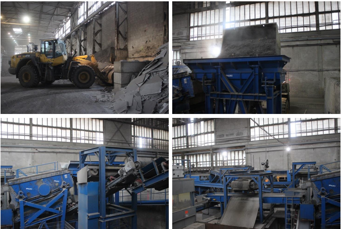
Aufgabe der Rohschlacken mittels Radlader (oben); Aufbereitungsanlage der MAV Kelheim (eigene Darstellung, Fraunhofer UMSICHT)
