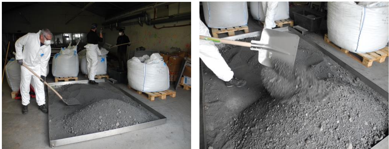
Herstellung des Gemisches aus Grob- und Feinanteil der Schlacke (eigene Darstellung, Fraunhofer IME).
