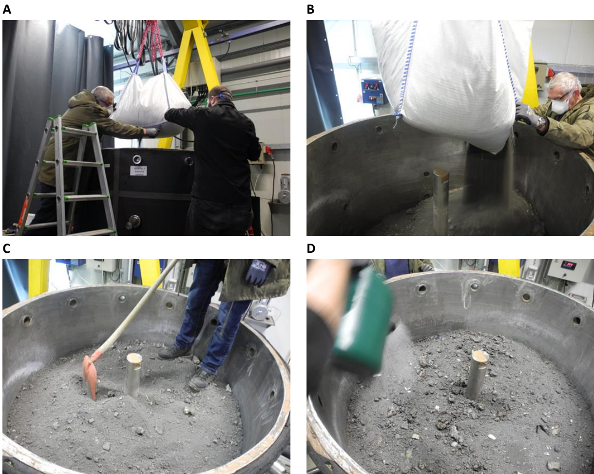
Einlagerung des Schlackegemisches (A + B + C) und leichte Befeuchtung während der Einlagerung (D). (eigene Darstellung, Fraunhofer IME).
