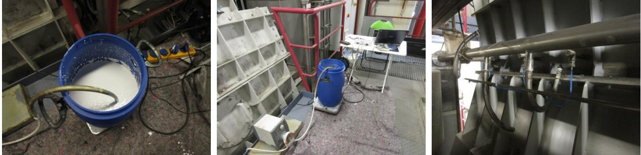
Abbildung 34: Eindüsung des Nanomaterials im GKS
