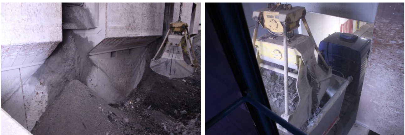
Abbildung 35: Verladung der Schlacke im GKS
