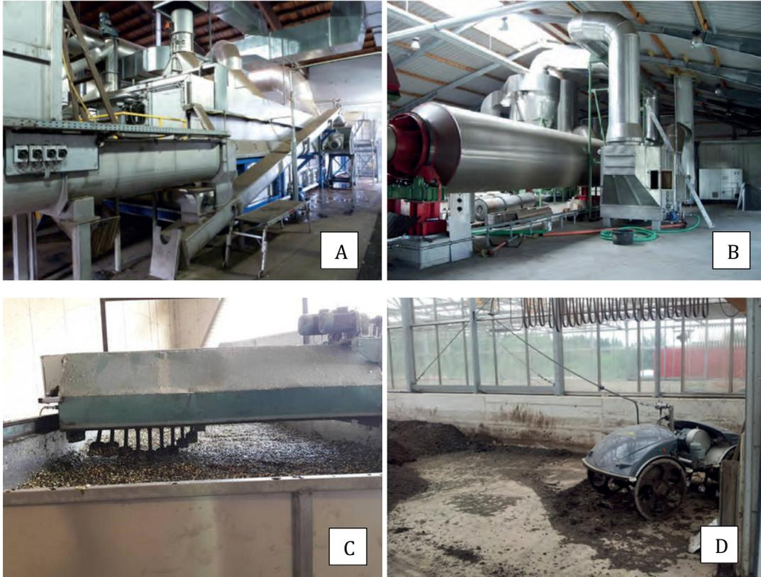
A) Bandrockner, B) Trommeltrockner, C) Schubwendetrockner, D) Solare Trocknung
